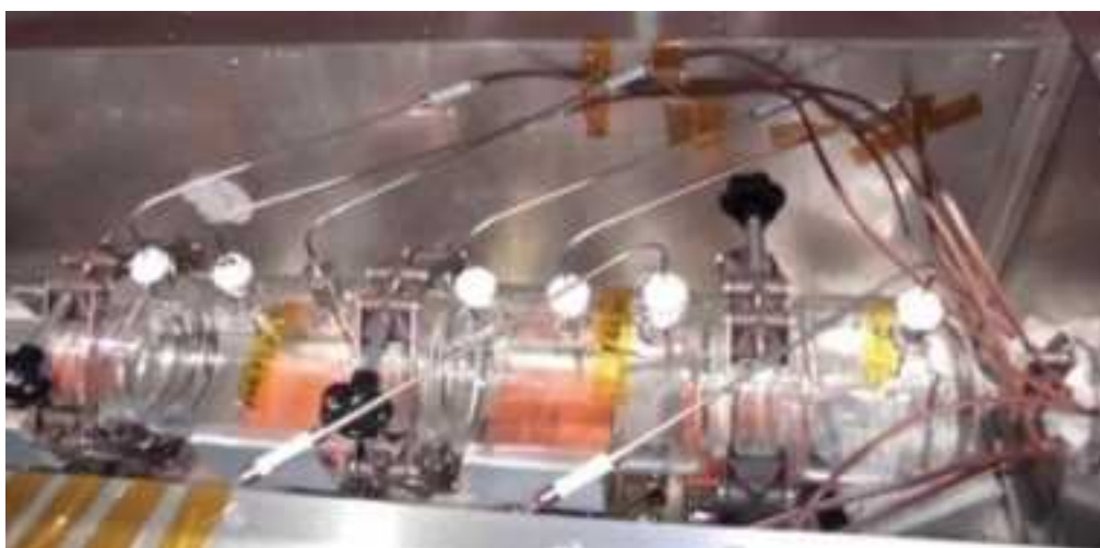
図 3-3 反応管写真および熱電対設置の様子
