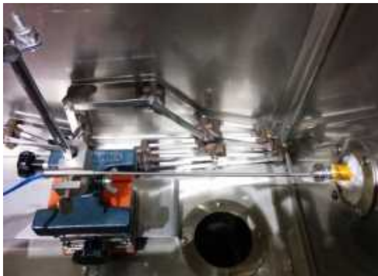
図 3-7 配管内温度測定の様子
