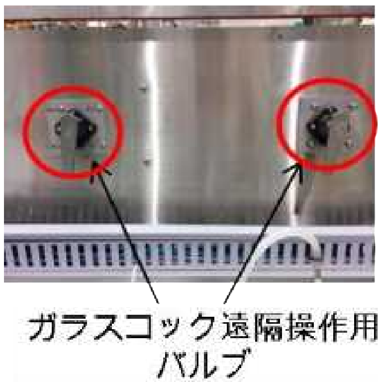
図 2-5 遠隔操作バルブ部の構造
