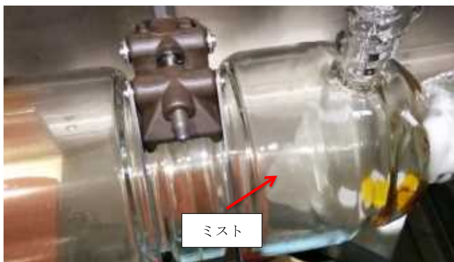
図 3-15 想定廃液温度 110 °C 条件における移行の様子
