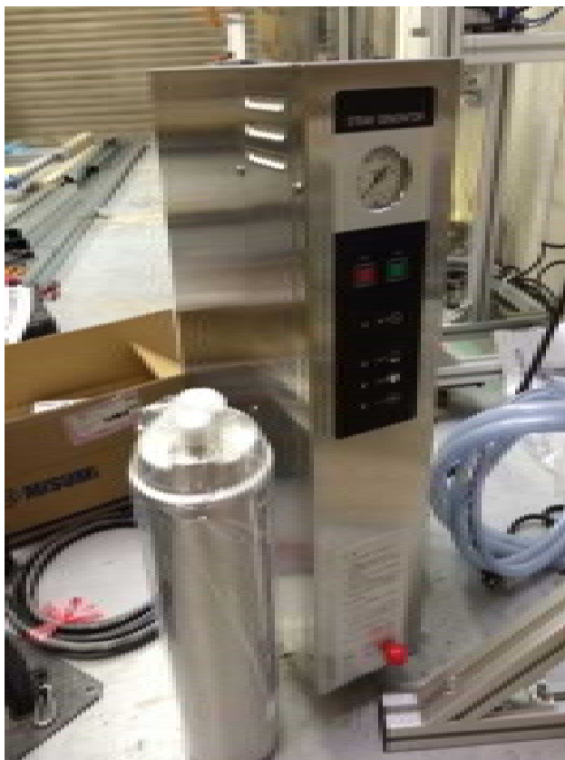
図 3-78 ボイラー及び軟水器
