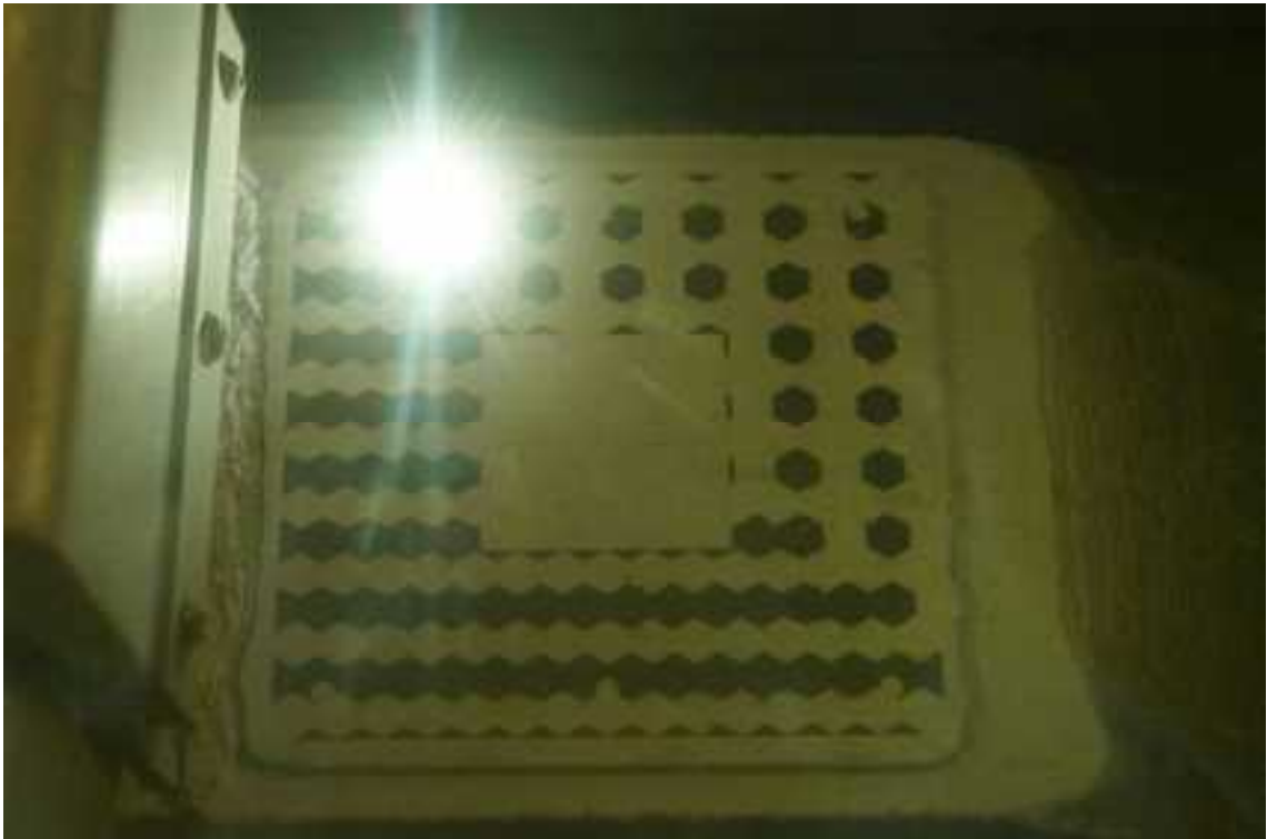
図 3-7 多孔質体三次元造型中の様子
