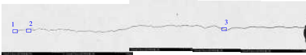
(a)疲労き裂全体の低倍観察(反射電子像)及び高倍観察箇所
