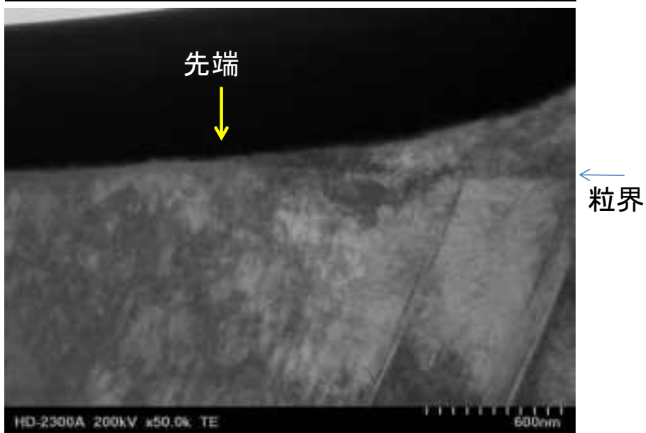
図 4.2.1.2-61 A413_先端のき裂先端マイクロ組織
