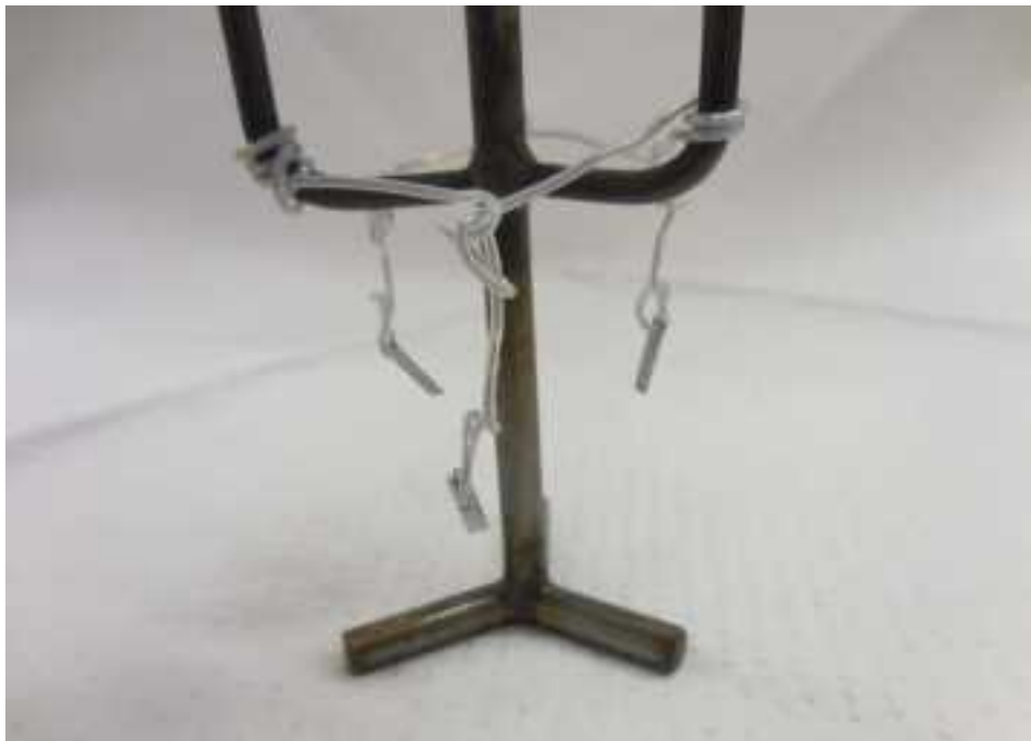
図 4.2.1.2-73 試験治具に取り付けた腐食試験片
