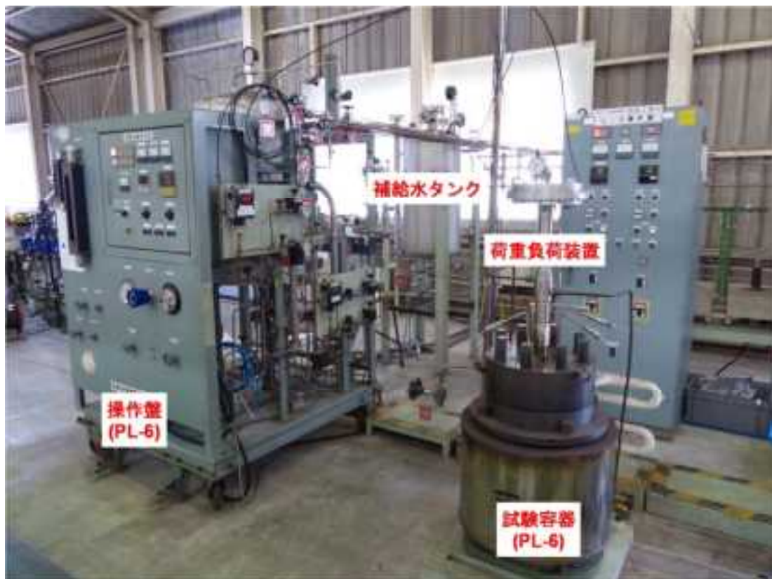
図 4.2.2-9 循環装置、タンク及び試験容器外観(PL-6)
