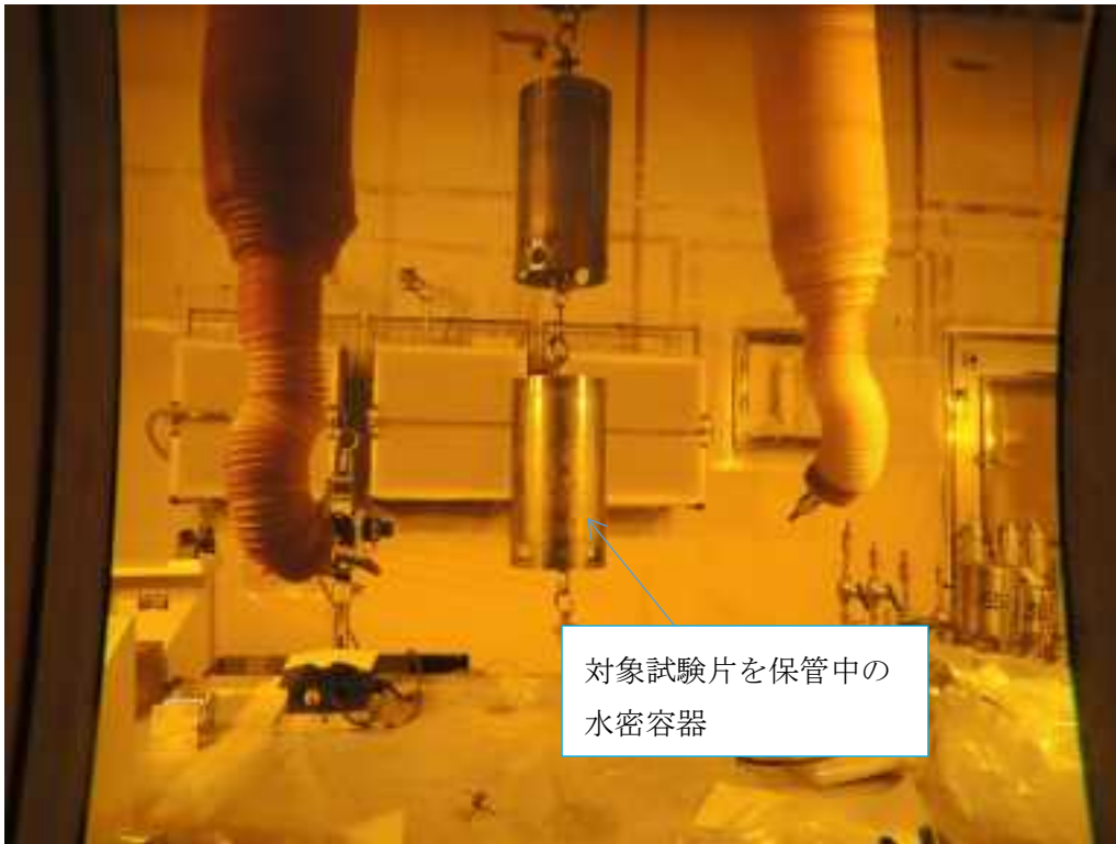
a. 対象試験片を保管中の水密容器のホットセルへの移動
