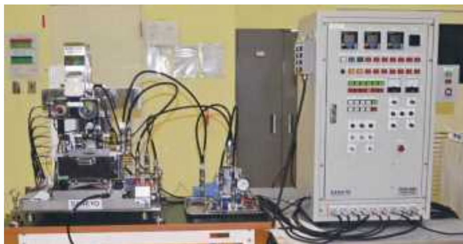
図 4.3.4-1 放電加工装置
