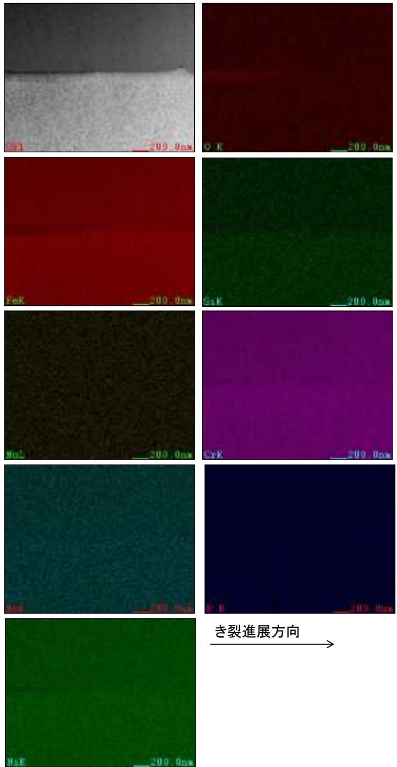
図 4.2.1.2-51 A412-先端(a)の EDS マップ
