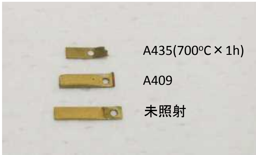
図 4.2.1.2-75 腐食試験片外観写真
