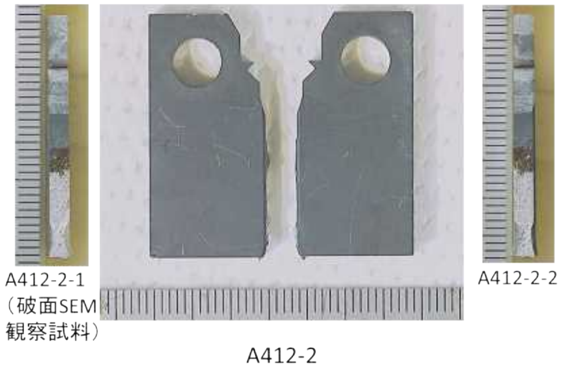
図 4.2.1.2-6 き裂進展試験後のデジタルマイクロスコープによる試験片外観観察結果 (A412(SUS316L 母材、 7.39 \times 10^{25} \text{n/m}^2 ( E > 1 \text{MeV} )))
