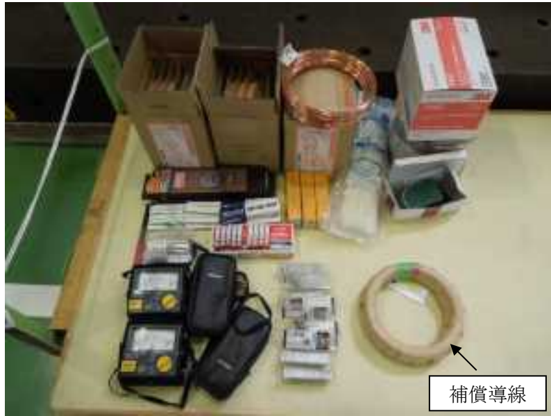
図 4.3.1-2 補修用品、補修用補償導線
