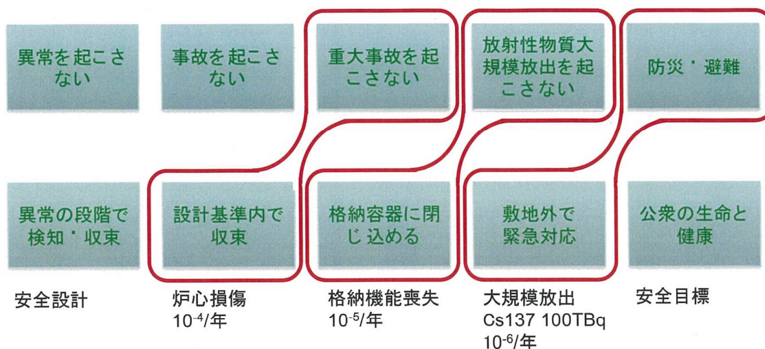
図 2.3.1-1 防止方策と緩和方策の適切な組み合わせによる深層防護
