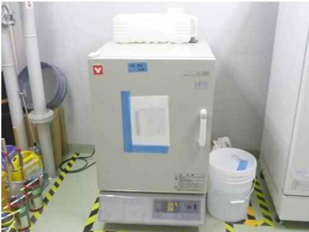
図 3. 2. 1-22 恒温恒湿槽：IG400（照射試験 1 列目模擬）
