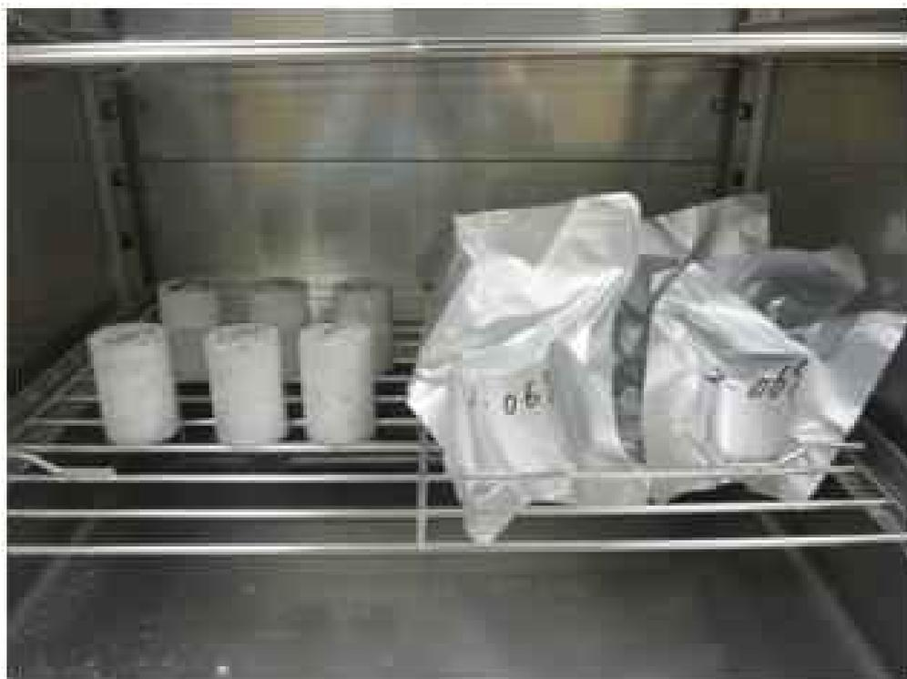
図 3. 2. 1-23 試験体設置状況（照射試験 1 列目模擬）
