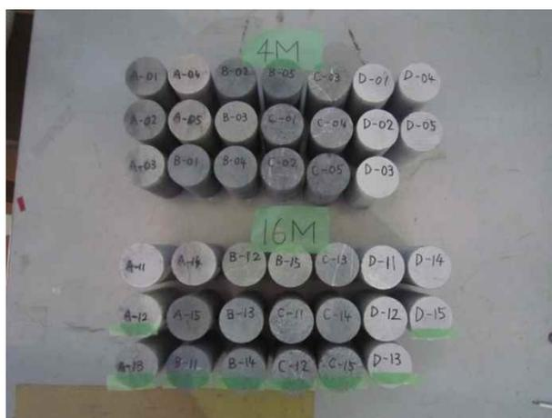
図 3.2.3-9 骨材試験体
