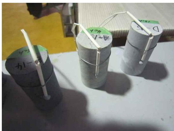
図 3.2.3-10 熱電対の取り付け状況
