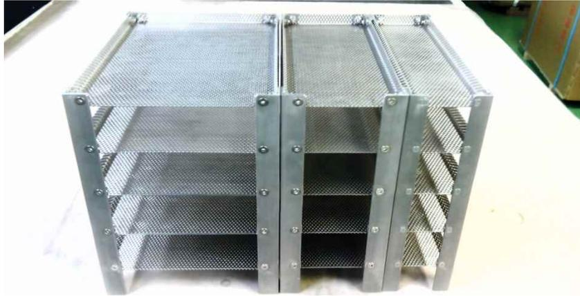
図 3. 2. 1-11 ステンレス製試験体設置棚
