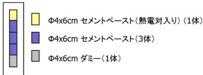
図 3.3.1-2 相互作用試験キャプセル内部の試験体の設置
