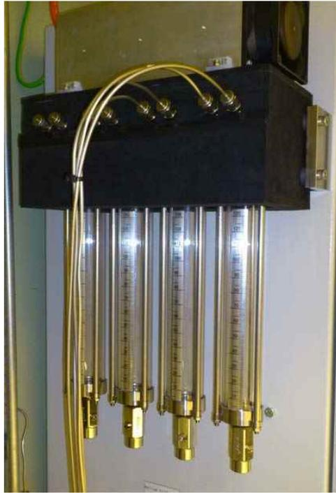
図 3.3.1- 20 水蒸気凝縮捕集容器（コンデンサ）
