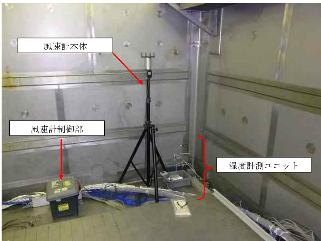
図 3.2.1-6 湿度計測ユニットおよび風速計測システム
