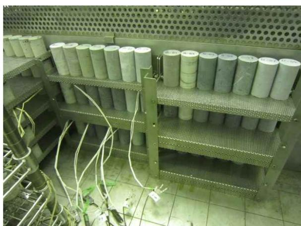
図 3.2.3-11 骨材試験体の照射状況
