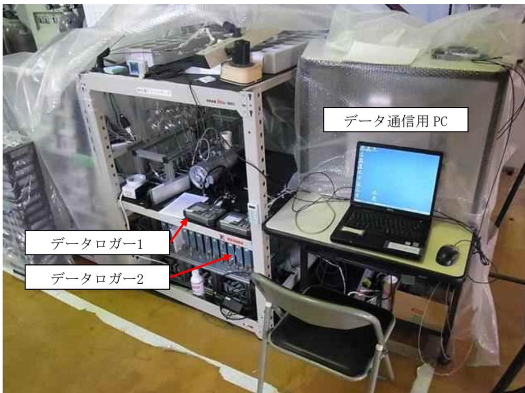
図 3.2.1-8 照射室外計測システム外観
