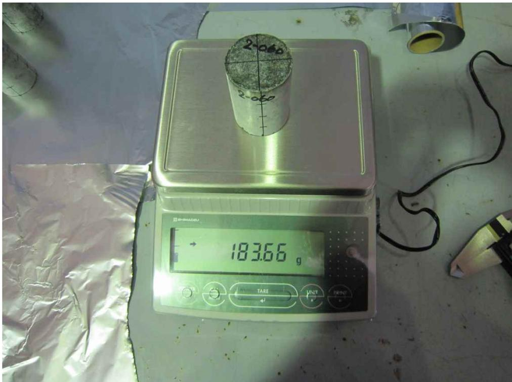
図 3.2.1-32 質量測定状況
