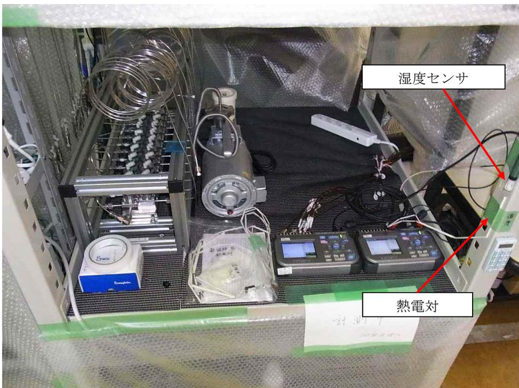
図 3. 2. 1-10 照射室外湿度センサおよび熱電対設置箇所
