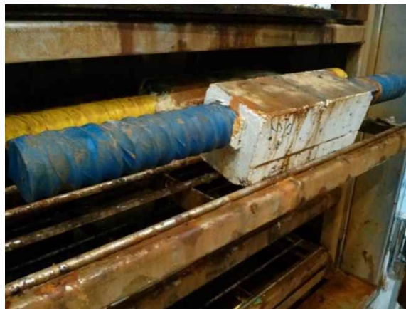
図 2.5.2-5 ひび割れを有するモルタル供試体の塩水噴霧試験の様子
