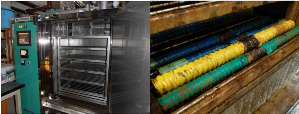
図 2.5.2-4 塩水噴霧試験の様子
