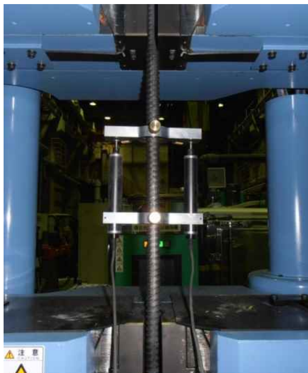
図 2.5.2-8 引張試験状況
