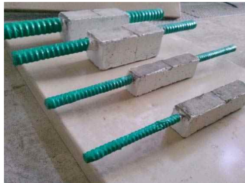
図 2.5.2-2 コンクリート中の鉄筋腐食試験用供試体
