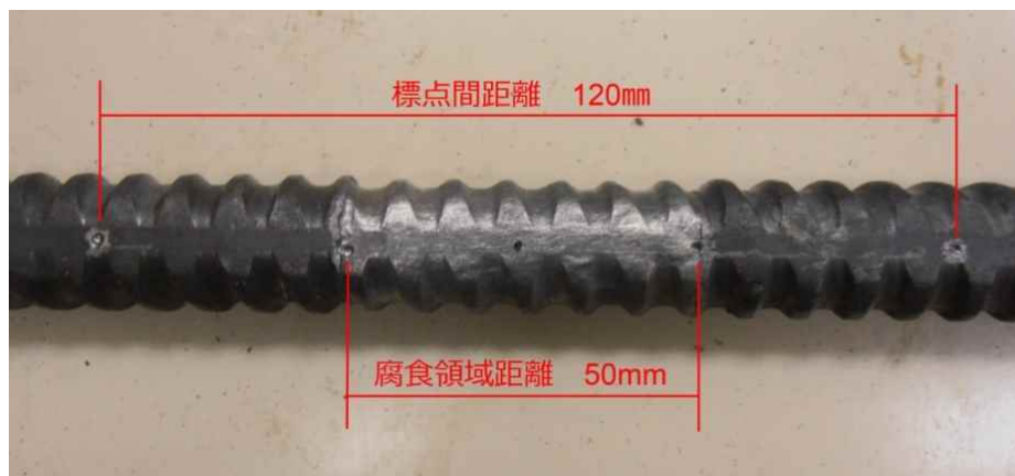
図 2.5.2-7 標点作製状況
