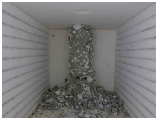
図 2.3.4-1 粗骨材に石灰岩を用いた供試体の加熱後の状況（加熱温度 700℃）
