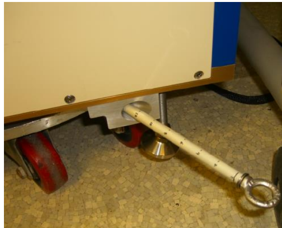
図 5. ^{252}\text{Cf} 線源を挿入棒に装着し、中性子測定装置下部に挿入したときの様子
