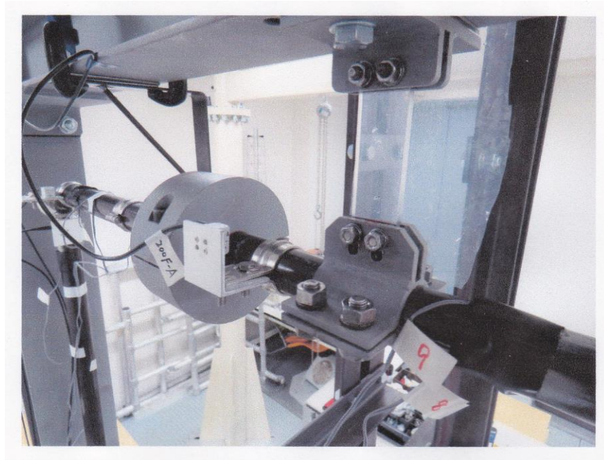
図 3.2-33(1) 加速度計とひずみゲージの設置状況(サポート A 近傍)
