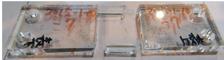
試験片 No.7 の破断状況
