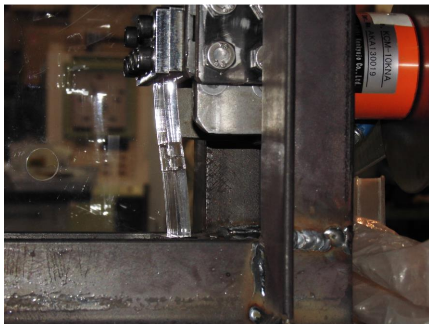
図 3.2-6(2) 静的加力試験の状況(アクリル板の変形状況)
