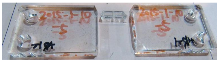
試験片 No.5 の破断状況
