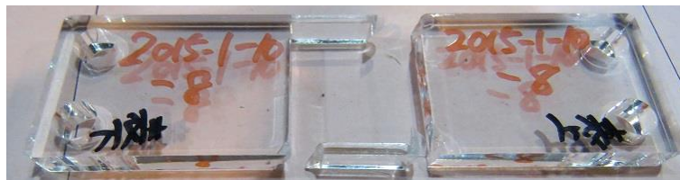
試験片 No.8 の破断状況
