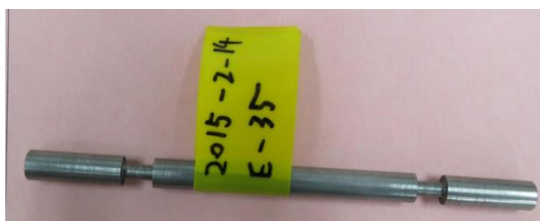
試験番号:2015-2-14-E-35(破断・亀裂なし)
