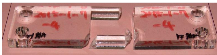
試験片 No.4 の破断状況
