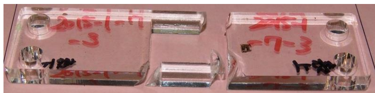
試験片 No.3 の破断状況
