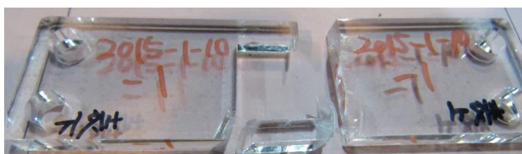
試験片 No.1 の破断状況
