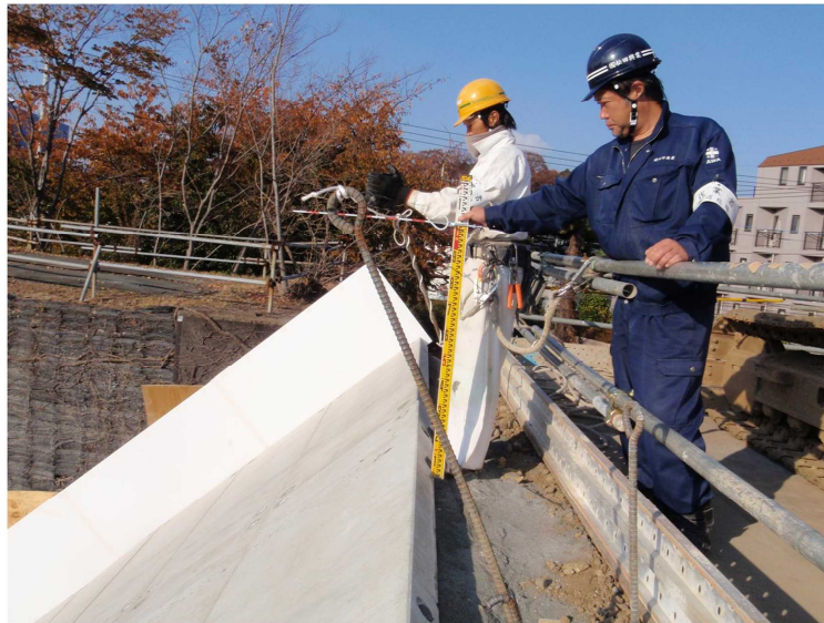
写真 3.1 大きさ 20cm の塊状岩塊を落下させるところ
