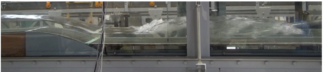
(c) 上流側で移動跳水，下流側では段波となり伝播している様子
