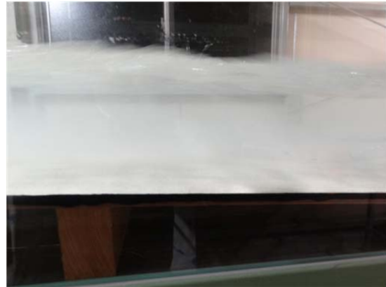
図 6-18 移動床区間を通過する津波
