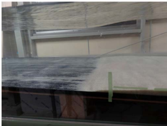
図 6-19 津波の流れによる砂の移動状況
