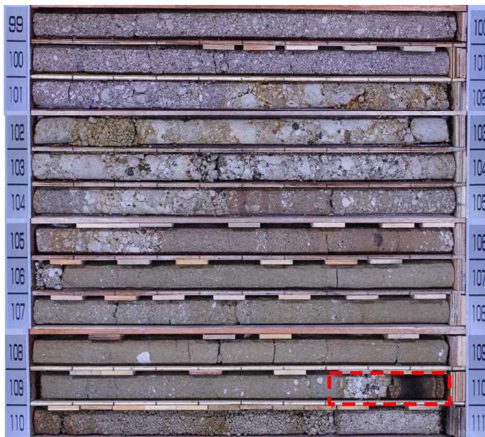
図10. ボーリングコア写真(深度99.00-111.00m).
