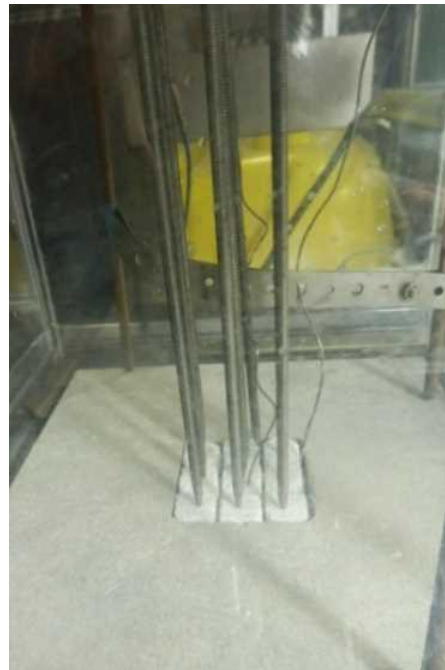
図 4-12 セラミック試験体との密着性を高めるサポートピン
