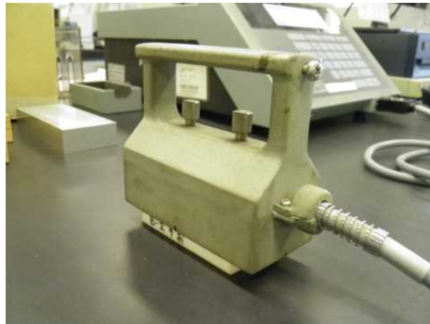
図 4-17 乾燥状態の熱伝導率測定状況
