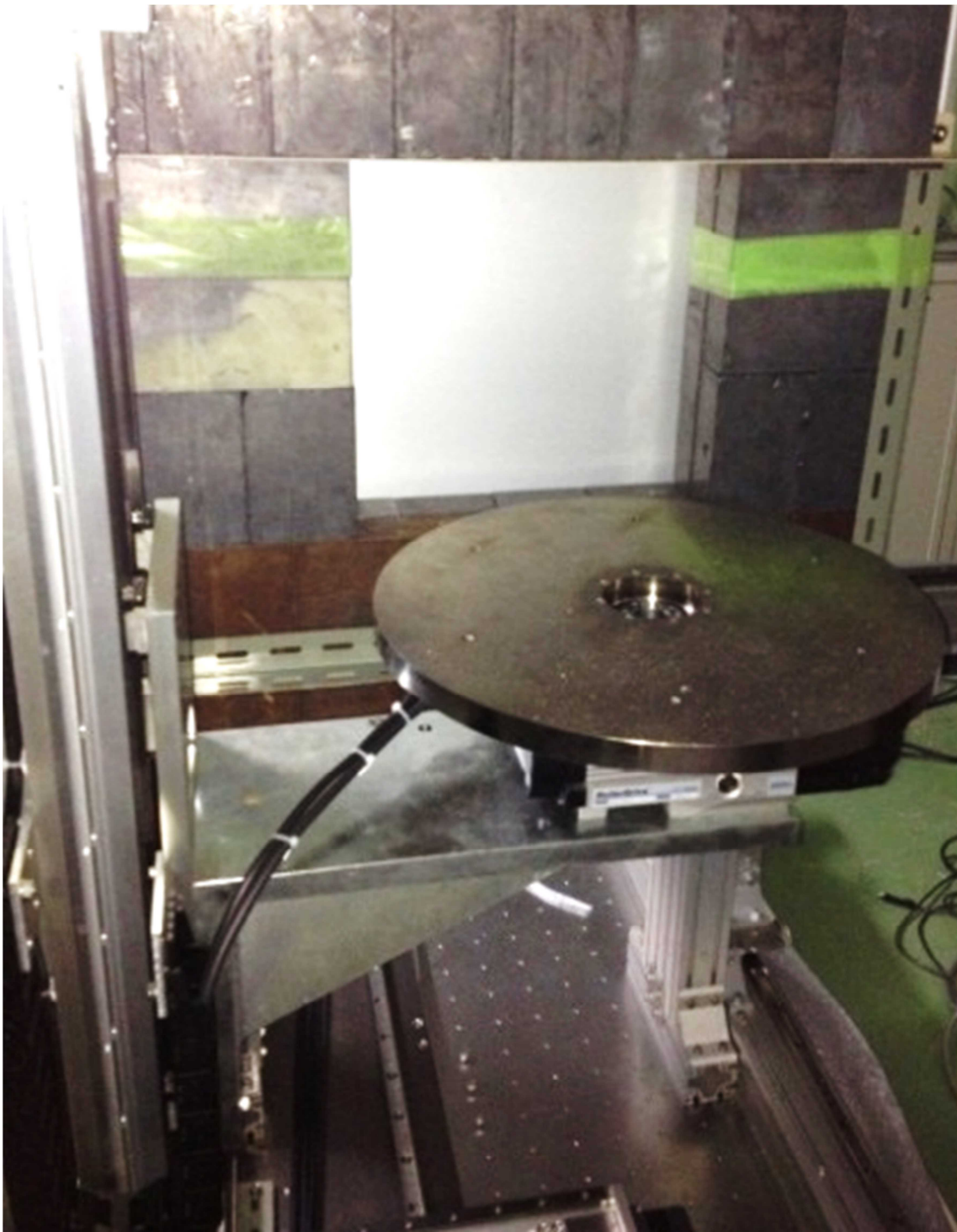
図 3-15 X線 CT 設備の回転試料台とフラットパネル
