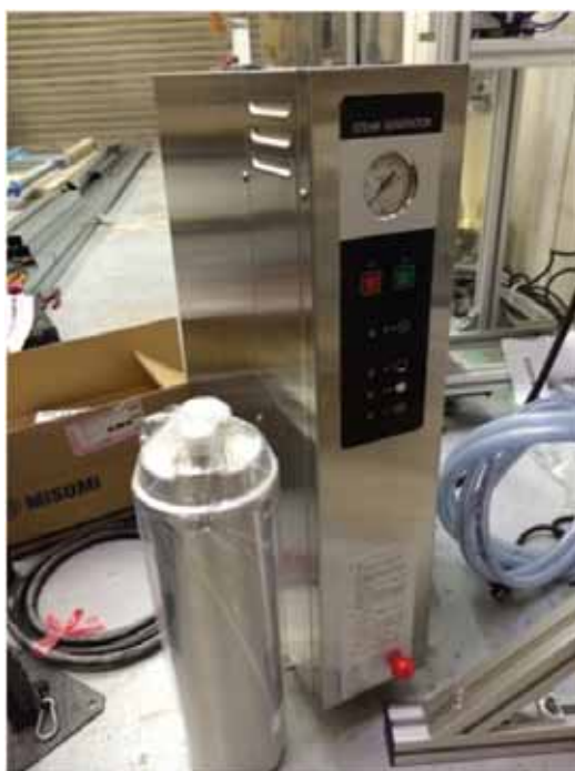
図 3-17 ボイラー及び軟水器
