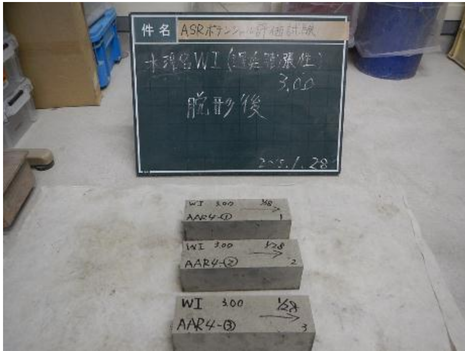
添付図 5-17 骨材種類：WI（遅延膨張性）、アルカリ総量：3.00kg/m 3 [38℃用：3本]
