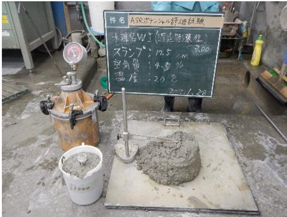
添付図 5-7 骨材種類：WI（遅延膨張性）、アルカリ総量：3.00kg/m 3
