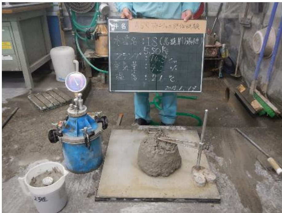
添付図 5-4 骨材種類：SI（急速膨張性）、アルカリ総量：5.50kg/m 3
