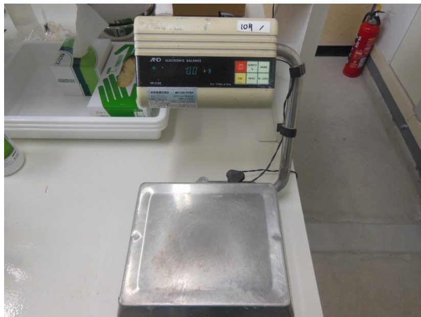
添付図 7-11 電子天秤 (CPT 重量の測定用)
