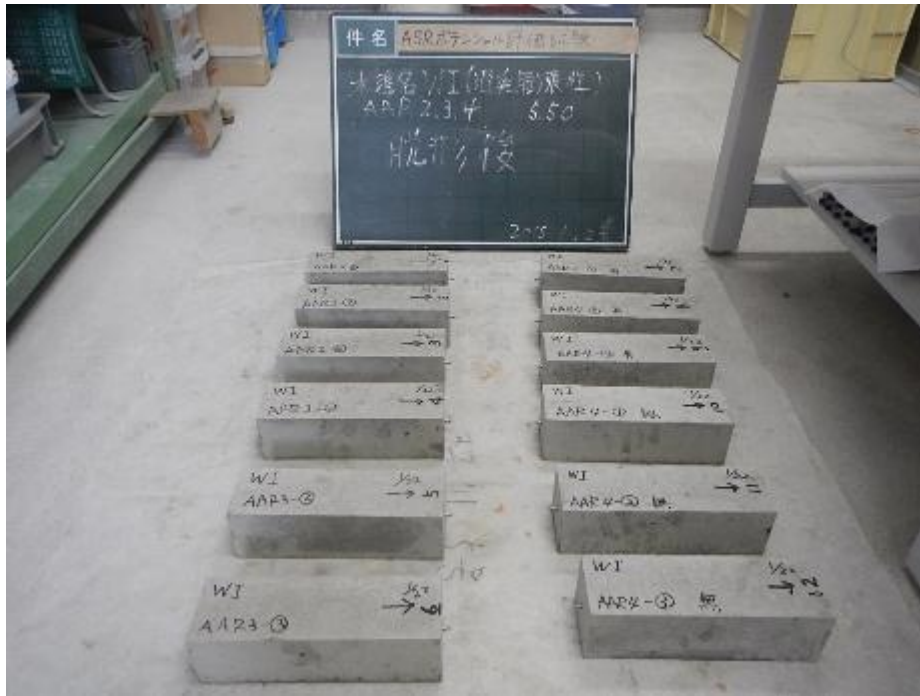
添付図 5-15 骨材種類：WI（遅延膨張性）、アルカリ総量：5.50kg/m 3 [20℃用：3本、38℃用：3本、60℃用：3本、60℃アルカリラッピングなし用：3本]
