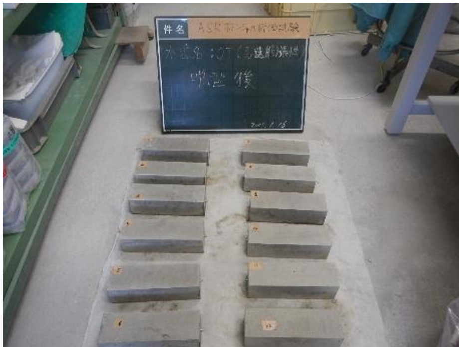
添付図 5-11 骨材種類：T0（急速膨張性）、アルカリ総量：5.50kg/m 3 [20℃用：3本、38℃用：3本、60℃用：3本、60℃アルカリラッピングなし用：3本]
