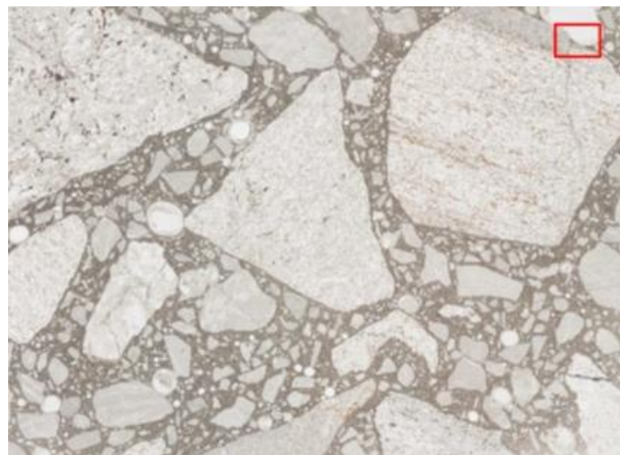
図 4. 4. 2-3 遅延膨張性骨材を使用した CPT 試験体薄片のスクャナー画像
