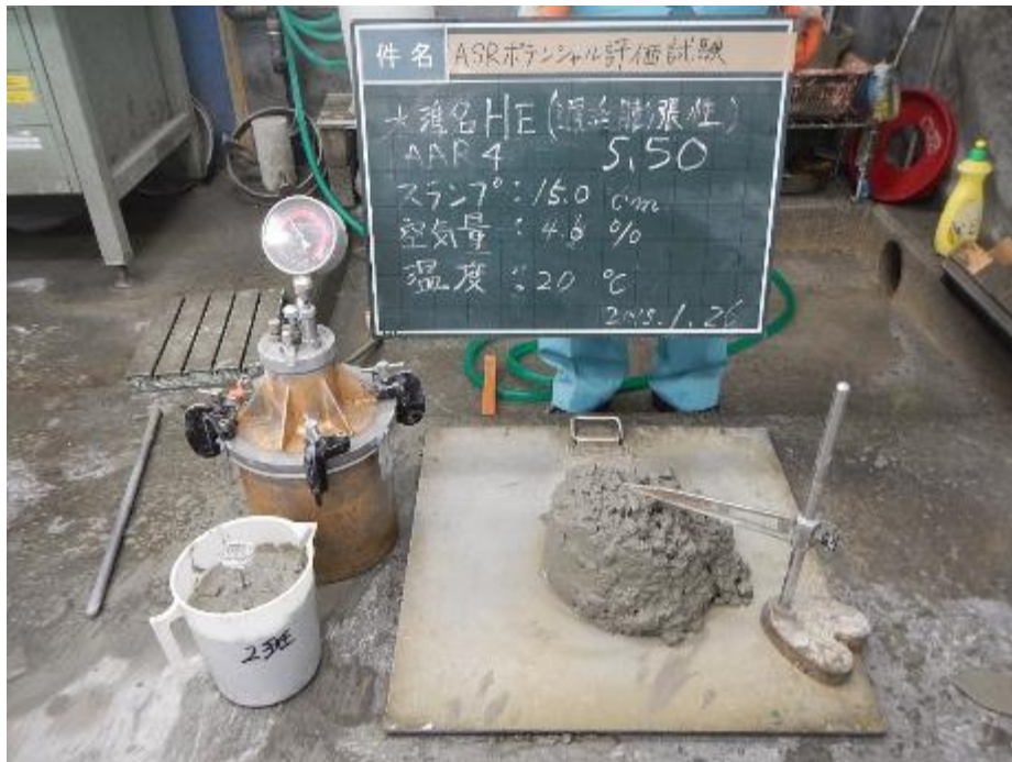
添付図 5-8 骨材種類：HE（遅延膨張性）、アルカリ総量：5.50kg/m 3
