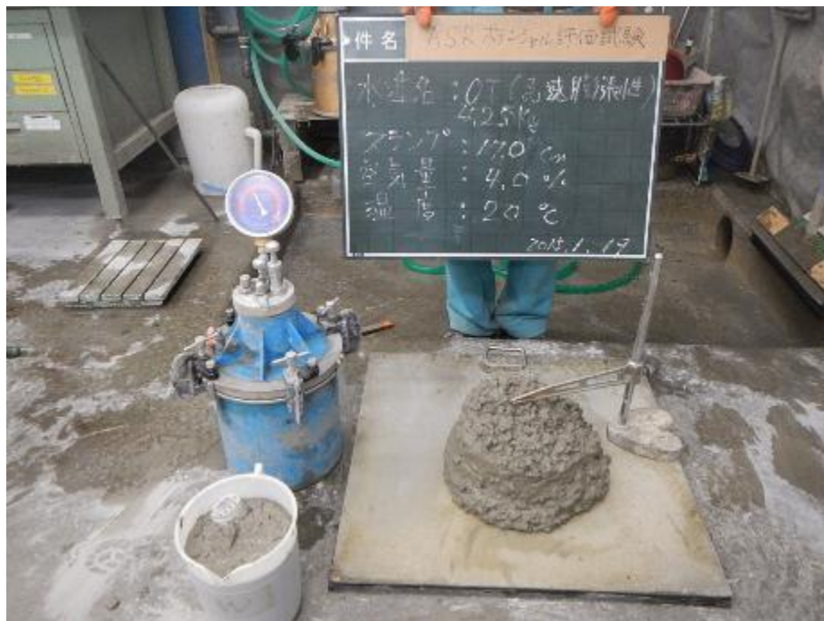
添付図 5-2 骨材種類: T0 (急速膨張性)、アルカリ総量: 4.25\text{kg/m}^3
