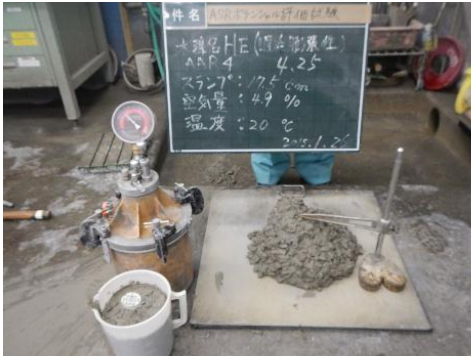
添付図 5-9 骨材種類：HE（遅延膨張性）、アルカリ総量：4.25kg/m 3
