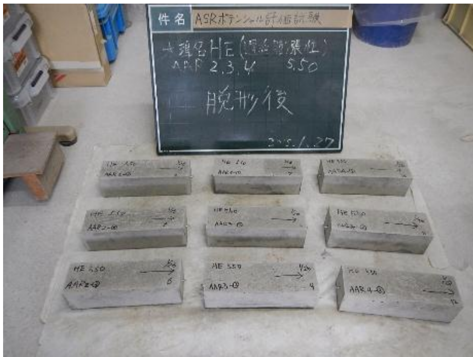
添付図 5-18 骨材種類：HE（遅延膨張性）、アルカリ総量：5.50kg/m 3 [20℃用：3本、38℃用：3本、60℃用：3本]
