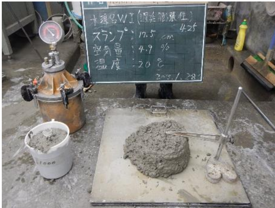
添付図 5-6 骨材種類：WI（遅延膨張性）、アルカリ総量：4.25kg/m 3
