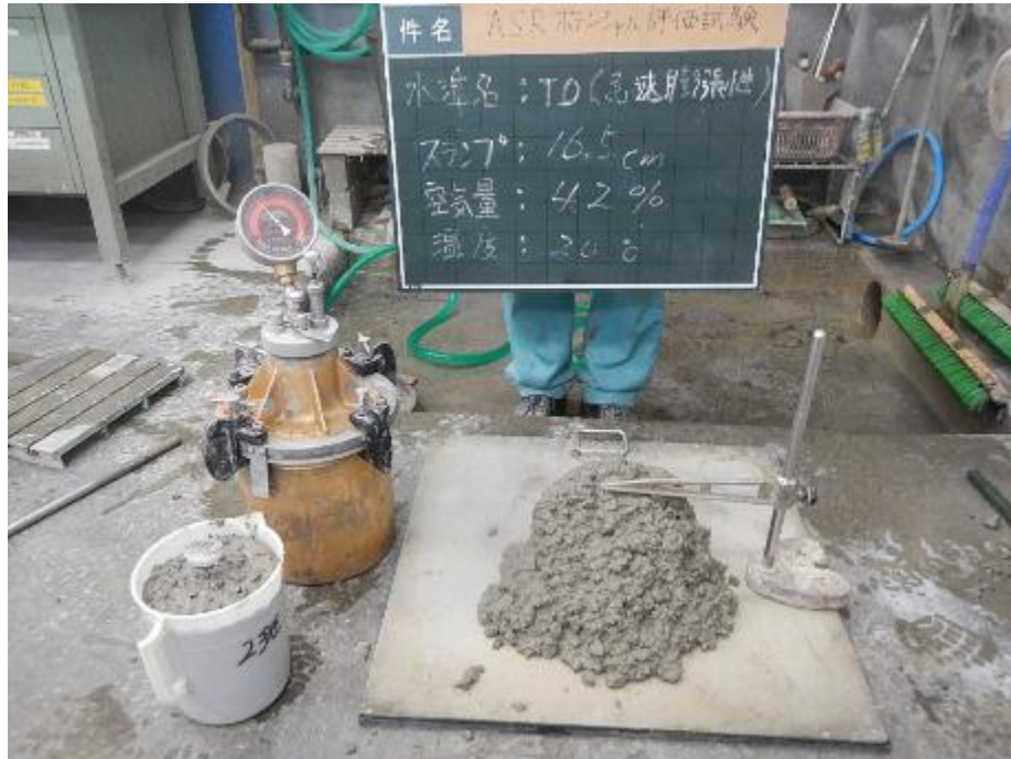
添付図 5-1 骨材種類: T0 (急速膨張性)、アルカリ総量: 5.50\text{kg/m}^3
