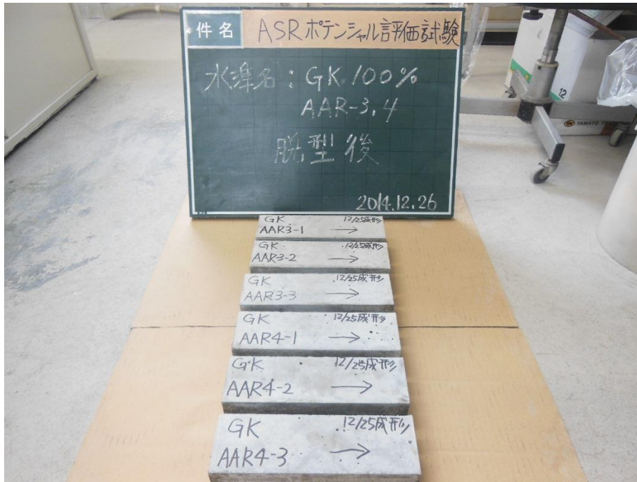
添付図 5-21 骨材種類：GK（遅延膨張性）、アルカリ総量：5.50kg/m 3 [38℃用：3本、60℃用：3本]
