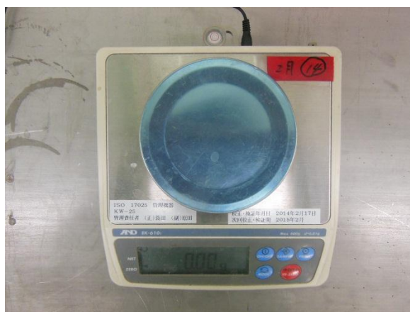
添付図 7-5 電子天秤 (JIS モルタルバー供試体重量の測定用)
