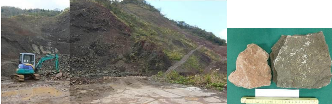
(a) 採石場(岩種により、赤っぽい岩石と黒っぽい岩石があり酸化により赤色を呈すると考えられる)
