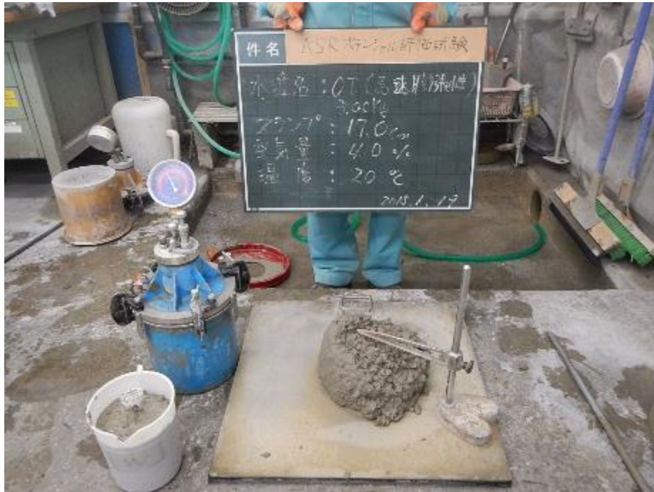
添付図 5-3 骨材種類：T0（急速膨張性）、アルカリ総量：3.00kg/m 3
