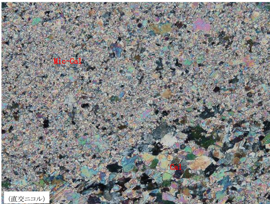
添付図 3-12 骨材 I0(石灰岩)の偏光顕微鏡観察結果
