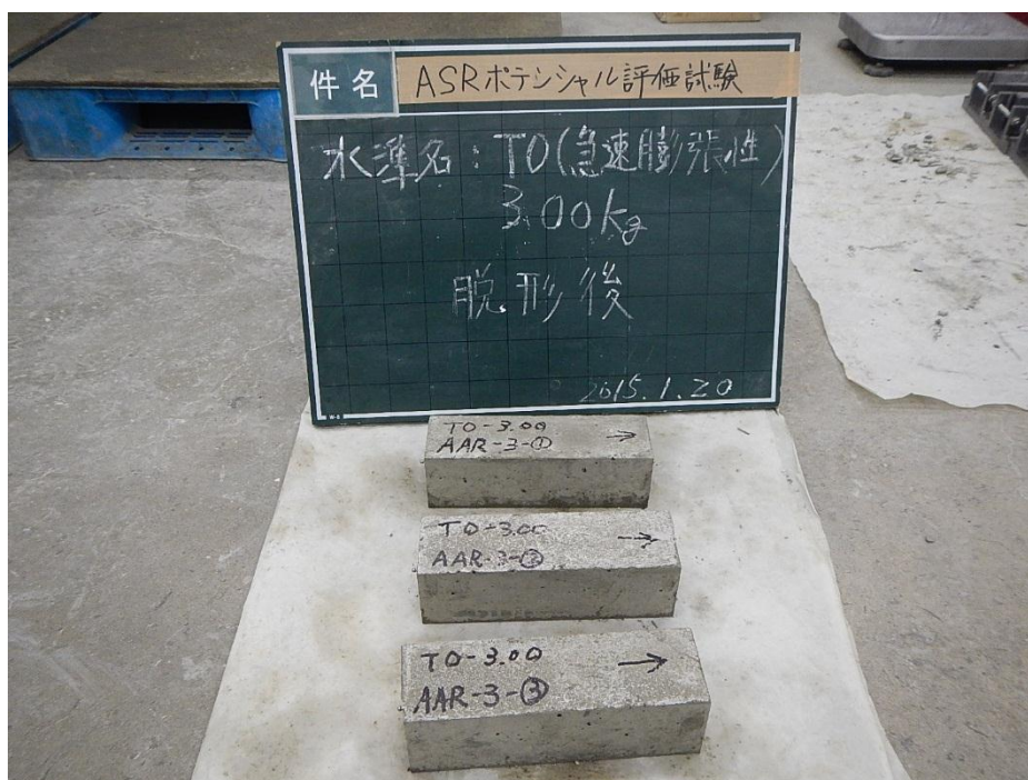
添付図 5-13 骨材種類：T0（急速膨張性）、アルカリ総量：3.00kg/m 3 [38℃用：3本]
