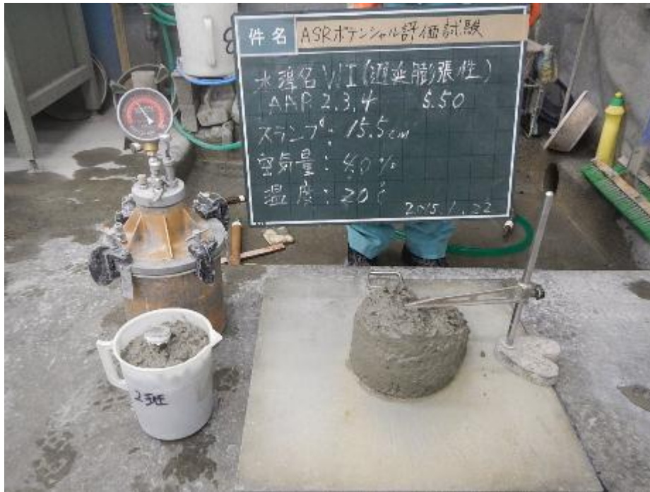
添付図 5-5 骨材種類：WI（遅延膨張性）、アルカリ総量：5.50kg/m 3
