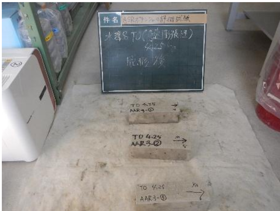
添付図 5-12 骨材種類：T0（急速膨張性）、アルカリ総量：4.25kg/m 3 [38℃用：3本]
