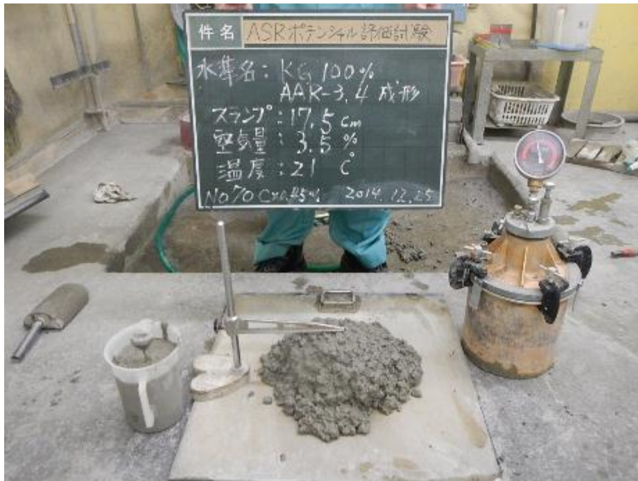
添付図 5-10 骨材種類：GK（遅延膨張性）、アルカリ総量：5.50kg/m 3
