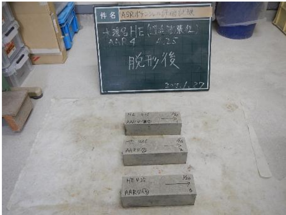
添付図 5-20 骨材種類：HE（遅延膨張性）、アルカリ総量：4.25kg/m 3 [60℃用：3本]
