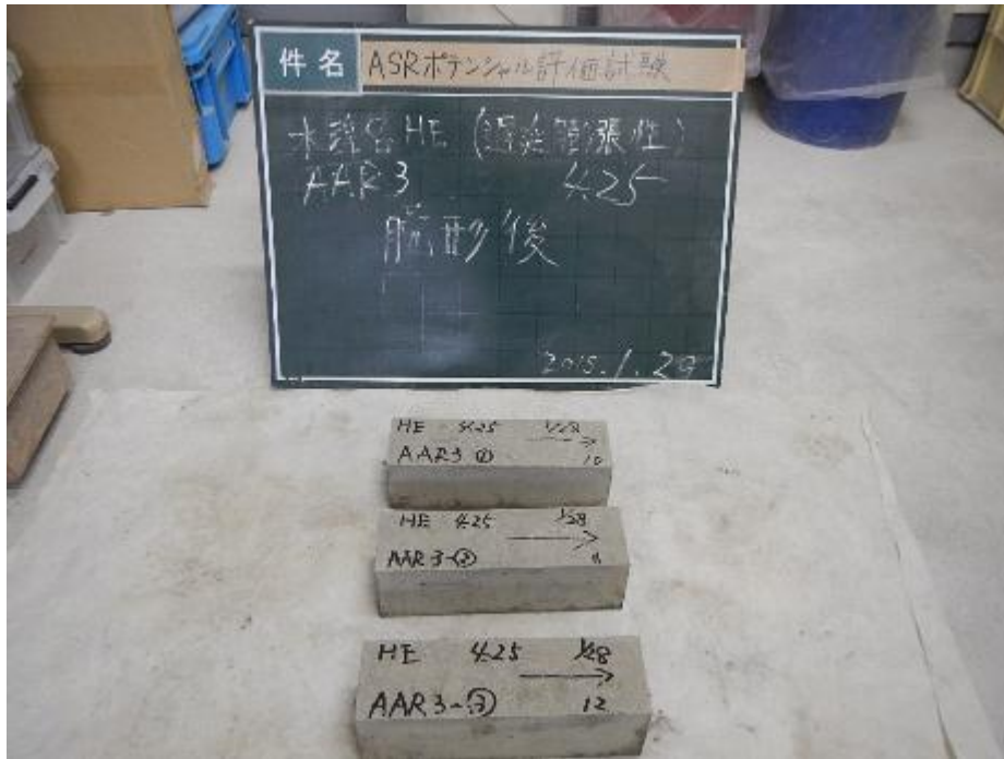
添付図 5-19 骨材種類：HE（遅延膨張性）、アルカリ総量：4.25kg/m 3 [38℃用：3本]
