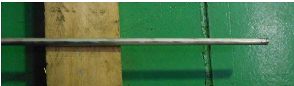
図 9.1.5-6 加振試験後の模擬燃料ピンの外観
