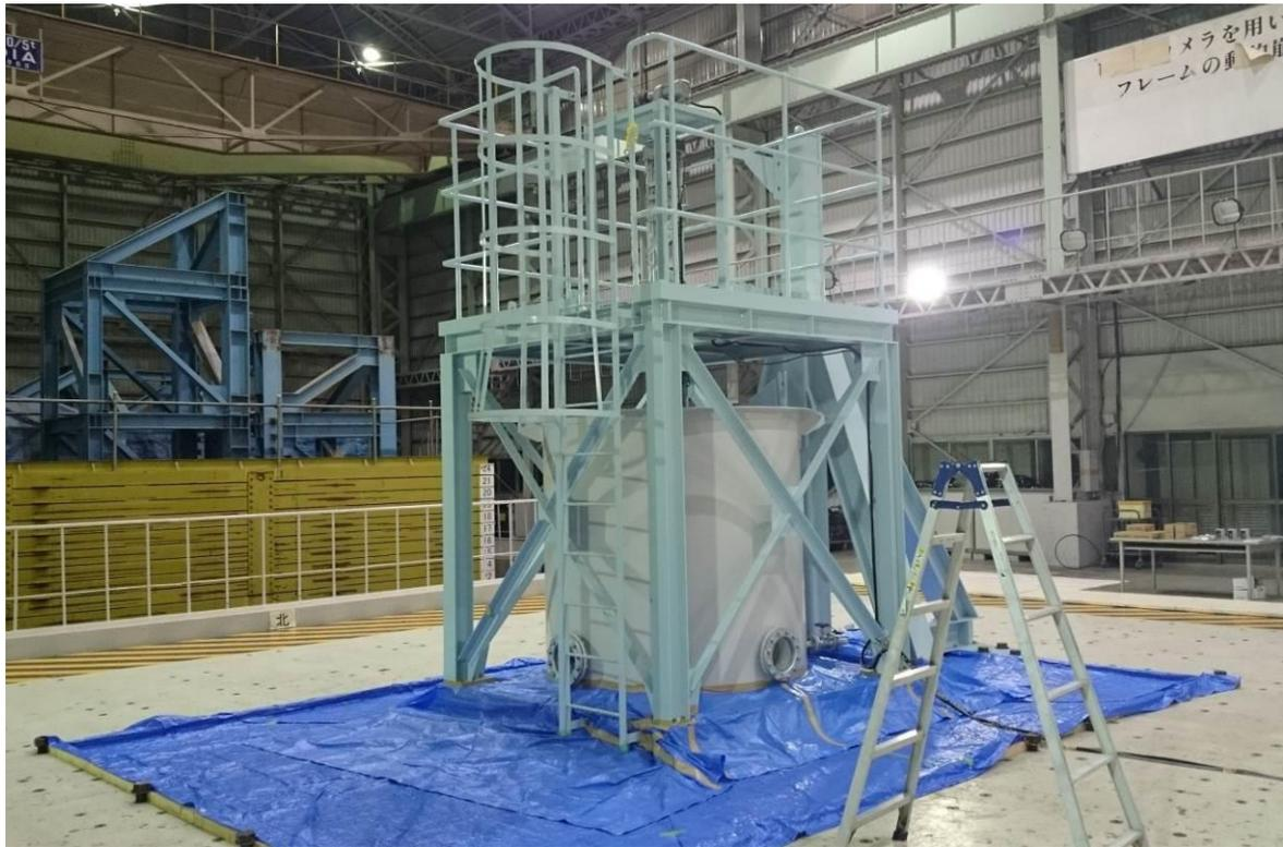
図 9.1.3-2 振動台に設置した試験装置の全体外観
