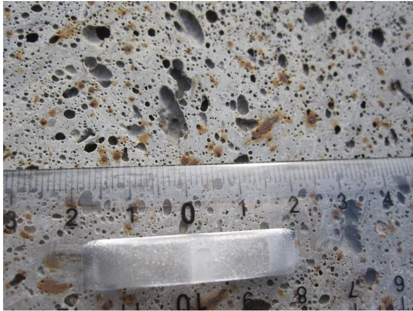
図 3-2 MOCKA 試験生成物（シリカ／ライムストーン=30/70）の写真
