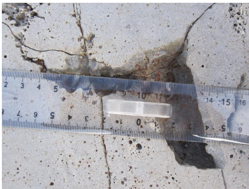
図 3-1 MOCKA 試験生成物 (シリカ/ライムストーン=50/50) の写真
