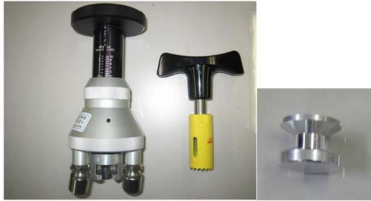
図 プルオフ法の試験機材 (左：付着性試験器、中：ドリルカッター、右：ドリリー)
