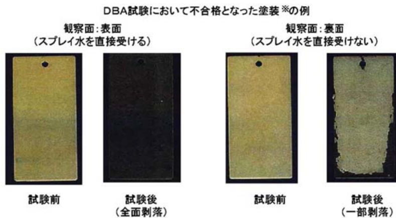
図 6. 6 スプレイ水を受ける面・受けない面での塗装剥落程度差異
