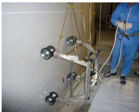
図3. 5 円筒部外面 遠隔目視用点検装置
