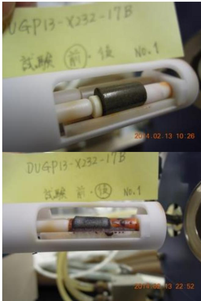
図 4.3.4.5-15 U-Si 系統 TD 試験後の試料部外観
