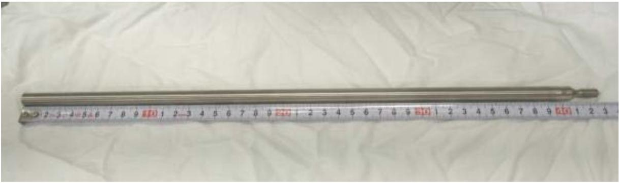
(試験用被覆管 (内径 9.596 mm、長さ 400 mm : 9×9BWR 被覆管相当品))
