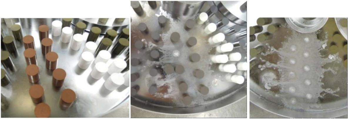
図 4.3.5-1 U-Zr-Fe-Ca 試料 (No.11) 焼結前後
