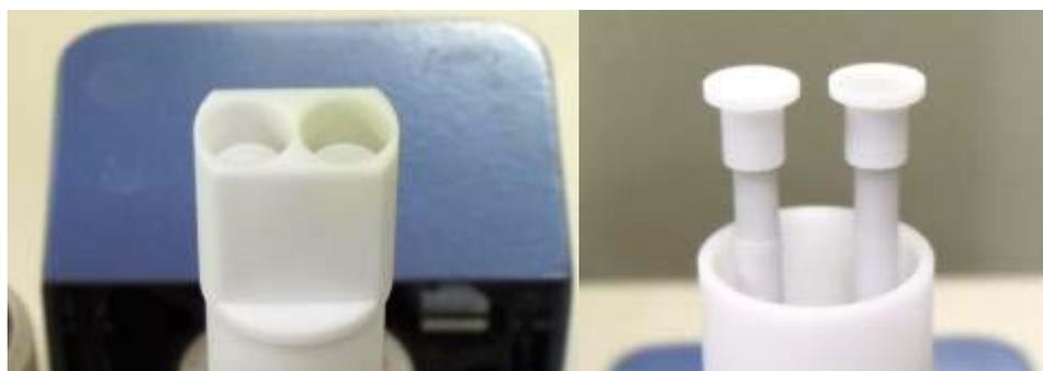
図 4.3.4.7-2 TG-DTA 試験装置天秤部
