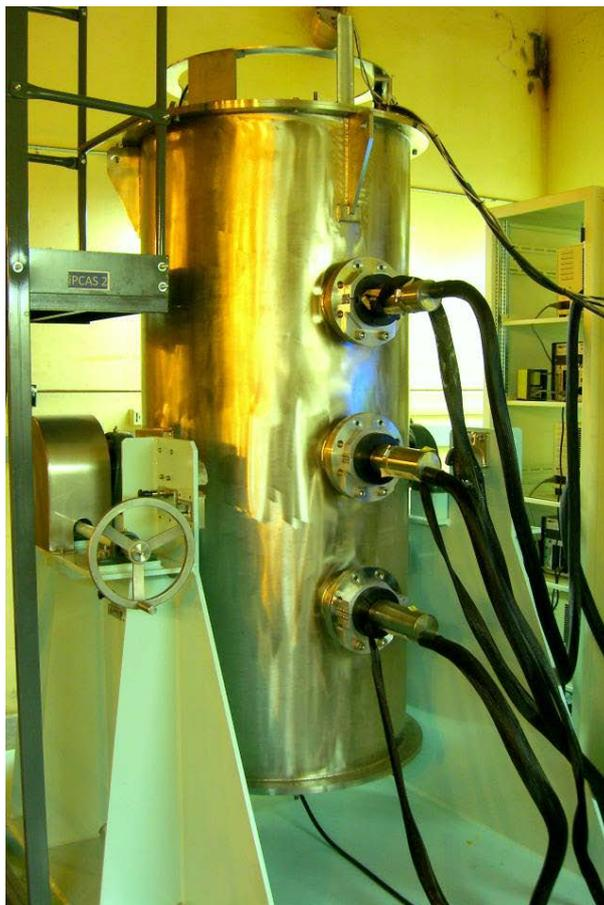
図 2. 架台に設置された IPCA (中性子検出器、ガンマ線検出器、ロードセルの一部及び仮の ID カメラ)
