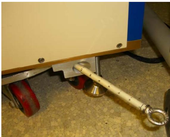
図 3.  $^{252}\text{Cf}$  線源を挿入棒に装着し、中性子測定装置下部に挿入したときの様子
