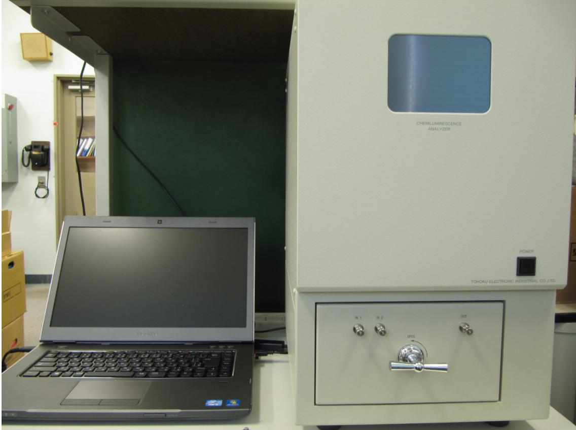
図 3.3.3- 1 微弱発光分析装置の概観
