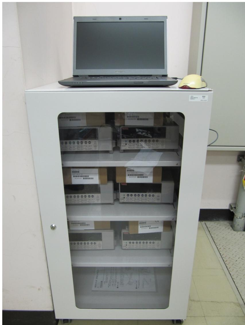
図 3.3.4-1 腐食電位測定装置の概観
