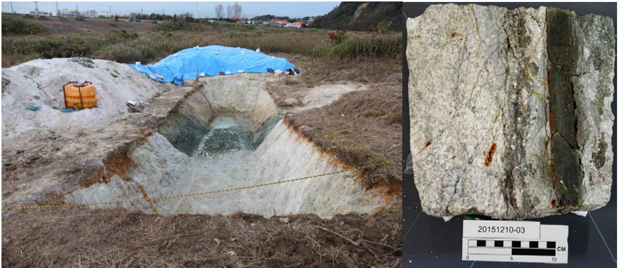
図 10 野島断層の分岐断層におけるトレンチ調査及び断層破碎物質の研磨面の例 Fig. 10 Example of trench survey and fault material at branch fault of Nojima Fault.
