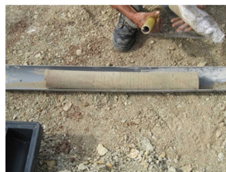
(b)ボーリングコア (養生前)
