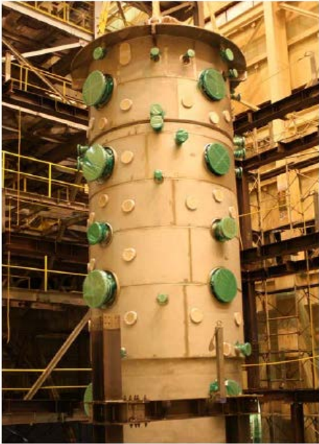
図 4 シビアアクシデント時格納容器熱流動試験
