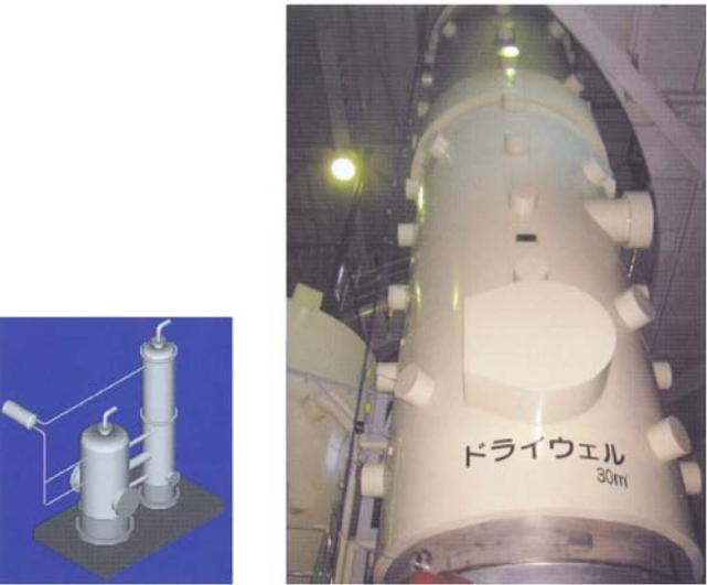
図 2 試験容器の例
