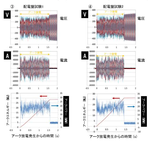
図 5 . 2 配電盤の HEAF 試験の波形 (電圧、電流及びアークパワー)
