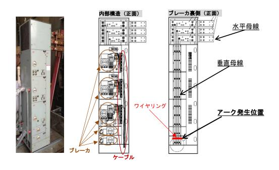
図3.6 試験に用いたモータコントロールセンタ Fig. 3.6 Motor control center used in the test
