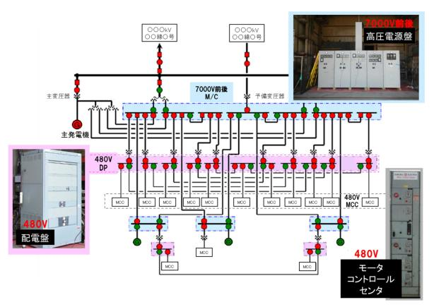
図3.1 原子力発電所の所内電気系統及び電気設備
