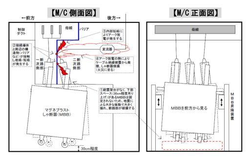
図2. 2 女川1号機の高圧電源盤におけるアーク放電の発生原因の推定図<sup>(参7)</sup> Fig. 2.2 Presumed cause of arc outbreak in metalclad switchgear of Onagawa NPS unit 1
