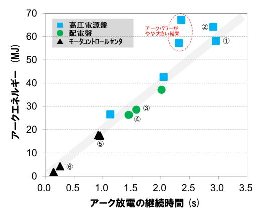
図5.4 アーク放電の継続時間とアークエネルギーの関係性 Fig 5.4 Relationship between arc duration and arc energy
