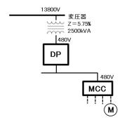
図3.2 DPとMCC (+モータ) の接続系統図
