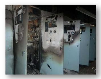
図2.1 女川1号機の高圧電源盤の HEAF による損傷状況(\*\*7)
