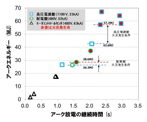
図 6.1 火災の発生に必要なアークエネルギー Fig 6.1 Arc energy necessary for causing fire
