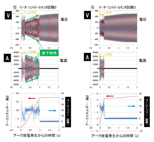
図 5.3 モータコントロールセンタの HEAF 試験の波形 (電圧、電流及び アークパワー)
