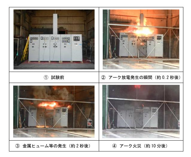
図4.1 高圧電源盤のHEAF 試験 Fig. 4.1 HEAF test of metalclad switchgear
