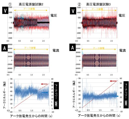
図 5. 1 高圧電源盤の HEAF 試験の波形 (電圧、電流及びアークパワー)
