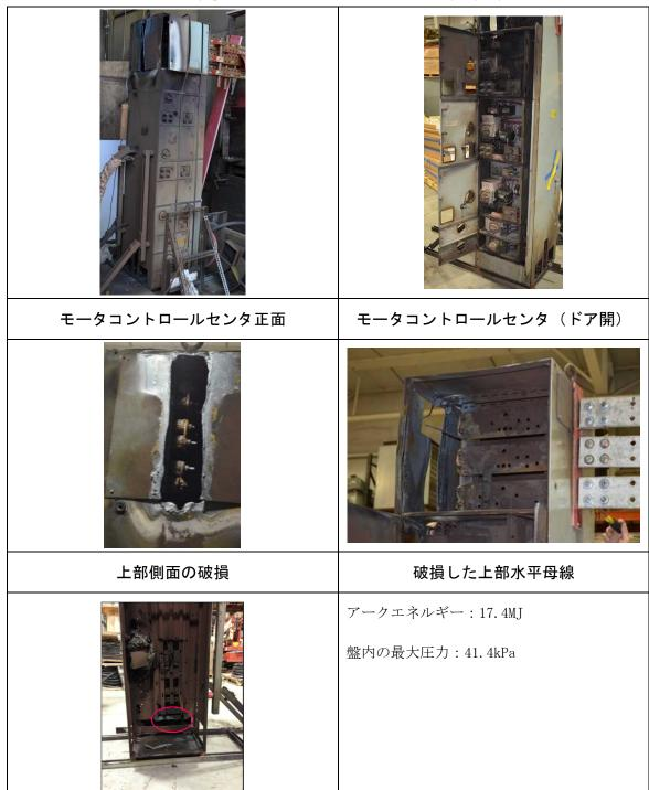
破損した垂直母線(アーク発生箇所)
