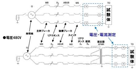
図3.3 HEAF 試験に用いた回路
