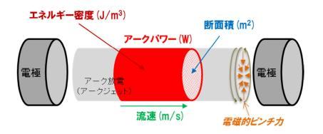
図 5. 5 アーク放電のエネルギーモデル Fig 5.5 Energy model of arc discharge
