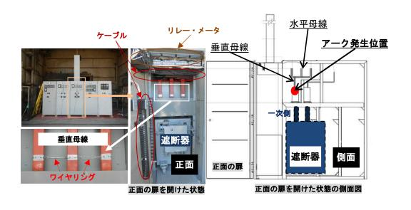
図3.4 試験に用いた高圧電源盤
