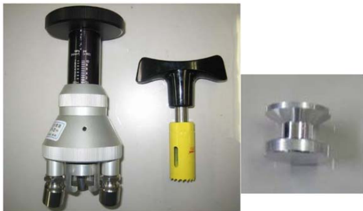
プルオフ法の試験機材 (左: 付着性試験器、中: ドリーカッター、右: ドリー)
