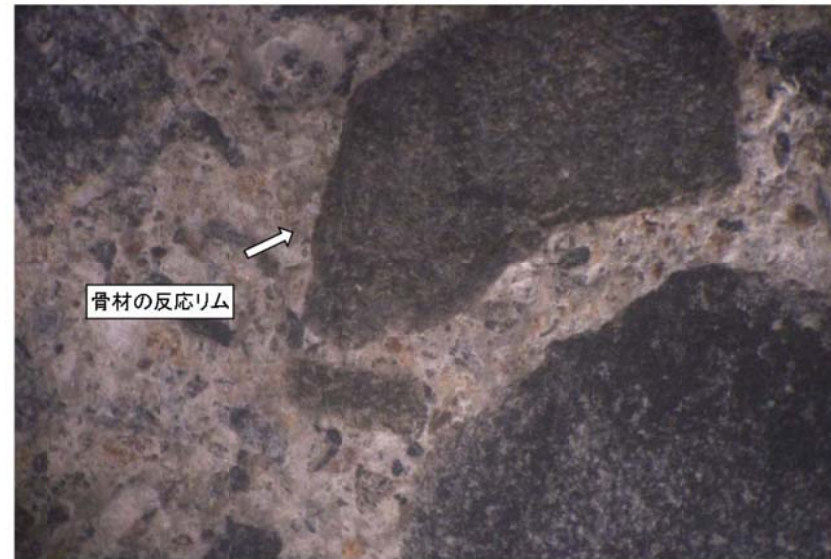
アルカリ骨材反応の点検状況 (実体顕微鏡観察状況)
