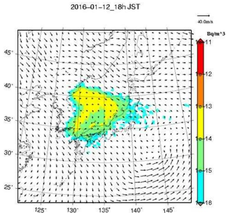
一般的に、地下核実験の場合は大気中に放射性物質が放出されることは想定されず、仮に放出があったとしても放出源情報が不明であるが、計算条件を仮定し拡散計算を実施。
