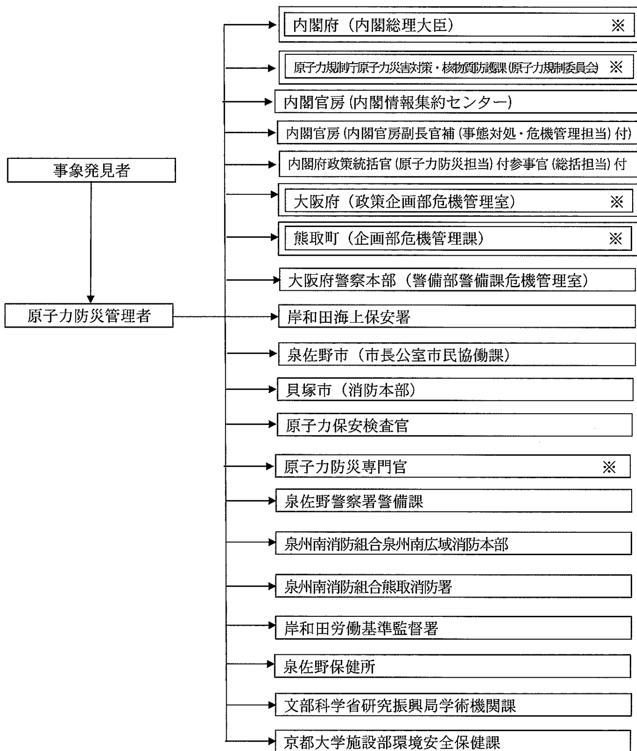
別図第3-1 原災法第10条第1項に基づく通報経路 実験所内での事象発生時
