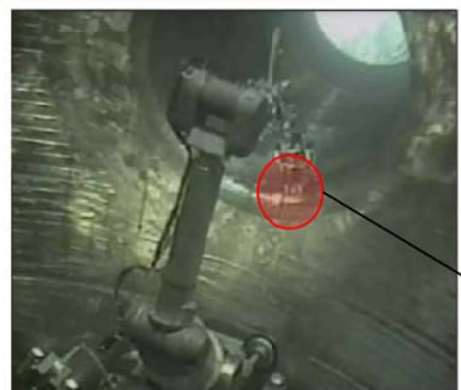
ノズルコーナー部探傷時は、ECT用の先端工具に取替
