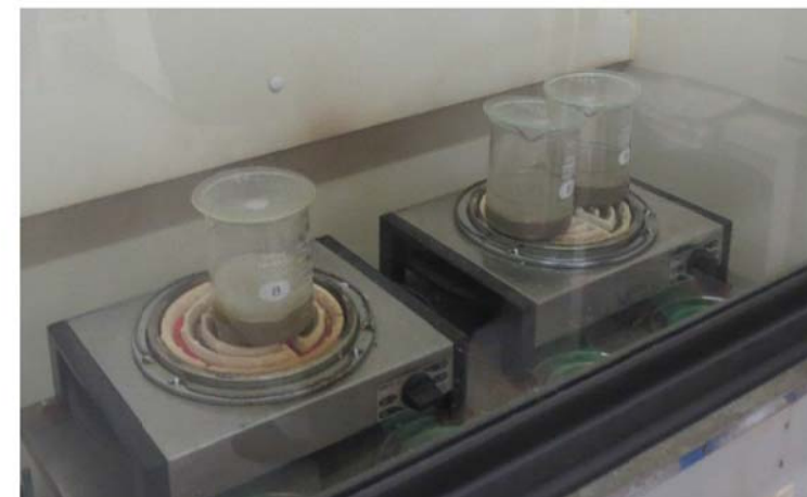
塩分浸透の点検状況 (塩化物イオンの抽出状況)
