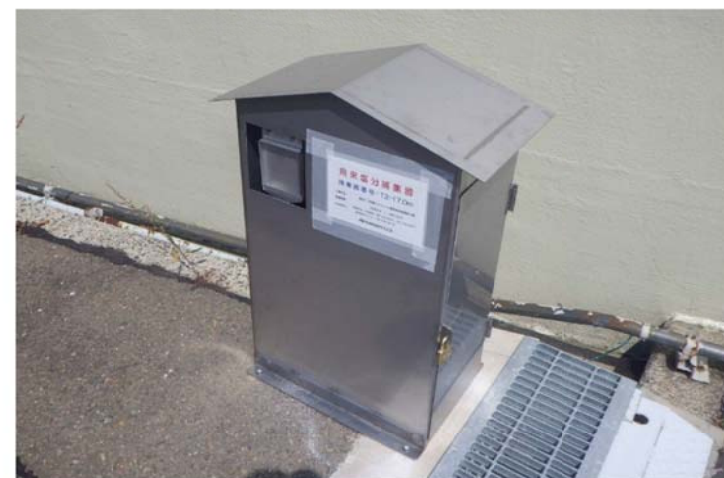
飛来塩分捕集器(土研式塩分捕集器)
