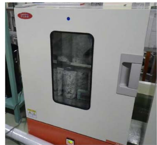
遮蔽能力の点検状況 (コアサンプルの乾燥状況)
