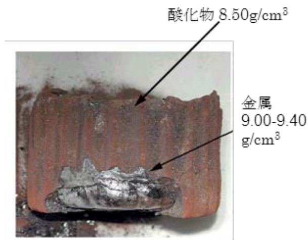
図 7 MASCA における MA 実験後のインゴット Fig.7 Ingot after MA Test in MASCA
