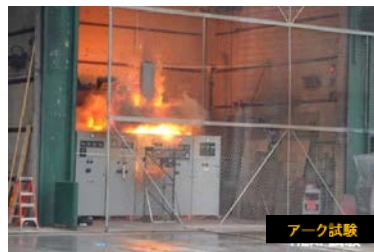
図 17. 高圧電源盤のアーカ試験
