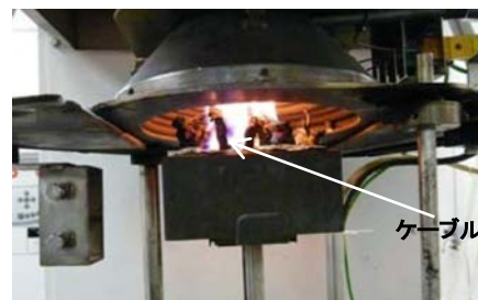
図9. コーンカロリメータ試験 Fig.9 Cone calorimeter test
