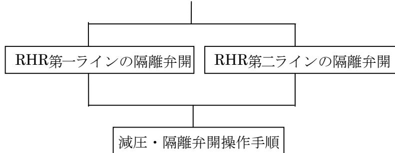
図 2 事例 44 および 46 に関する安全防護層の説明図
