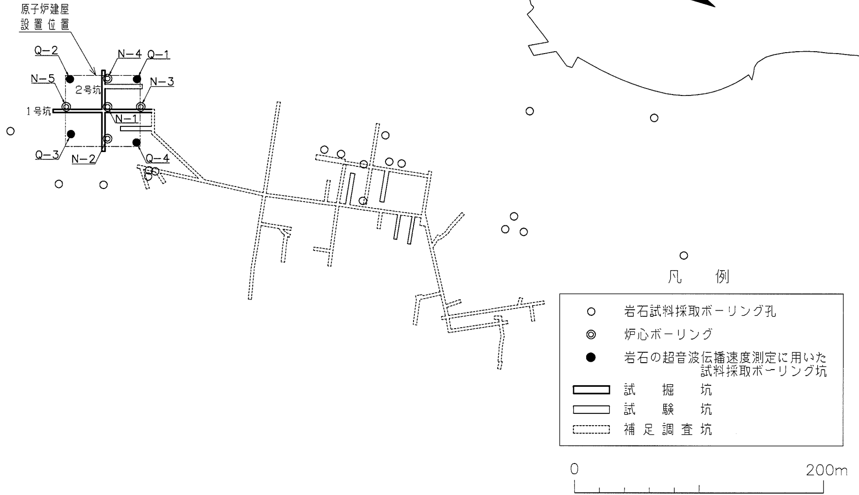
図-5.1 岩石の超音波伝播速度測定に用いた試料採取ボーリング坑位置図
