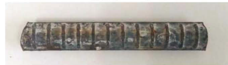
No.2 (腐食グレードI)
