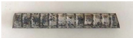
No.3 (腐食グレードI)
