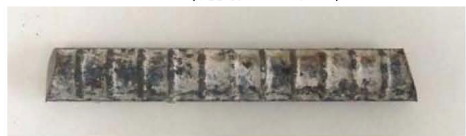
No.3 (腐食グレードI)
