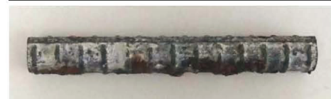
No.1 (腐食グレードII)
