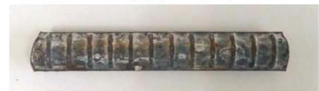
No.2 (腐食グレードI)
