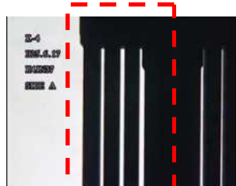
C面からの透過光による 燃料棒-ウォータ・ロッド間隔の A面からの確認
