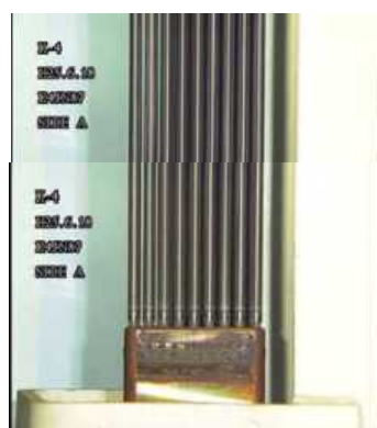
A面からの燃料棒外観確認
