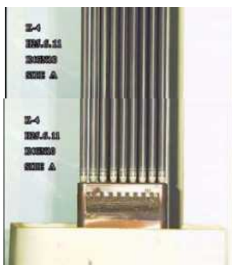
A面からの燃料棒外観確認
