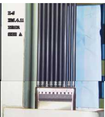
A面からの燃料棒外観確認
