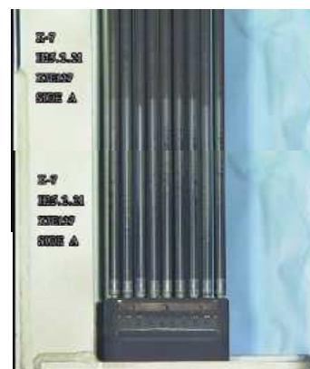
A面からの燃料棒外観確認
