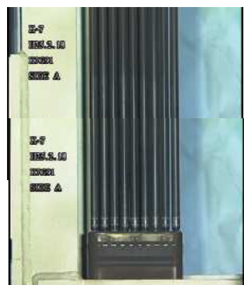
A面からの燃料棒外観確認
