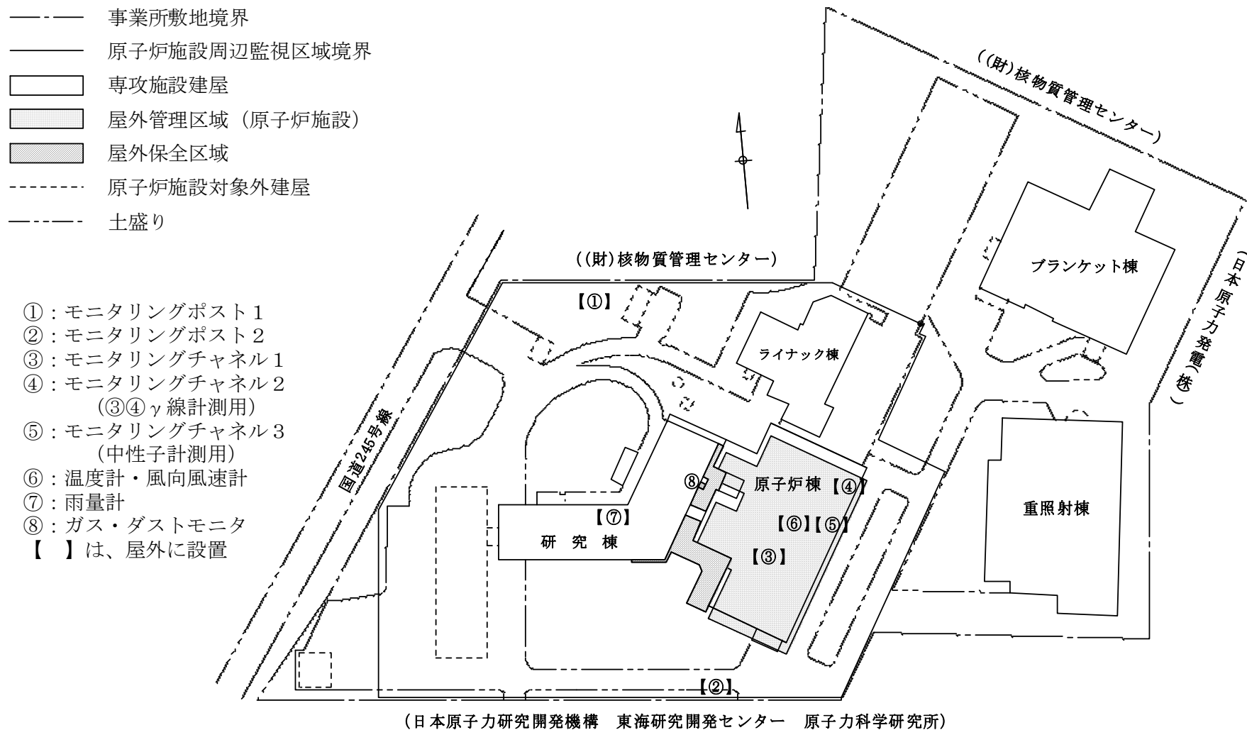
別図1 事業所敷地境界と放射線測定設備配置場所
