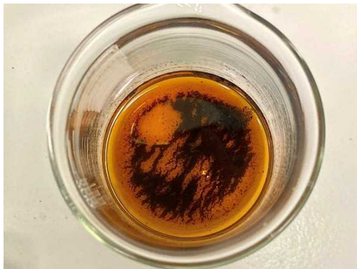
(3) ヨウ化パラジウム沈殿の様子
