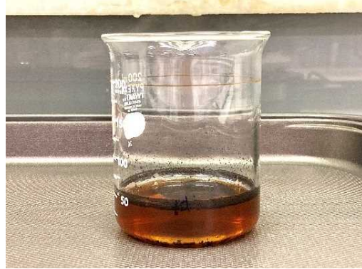
(2) 沸騰するまで加熱し、沈殿を生成する。
