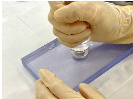
(4) 押さえ棒でリングがはまるまで 押さえる。
