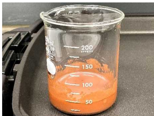
(2) 塩化パラジウムに純水を加える。
