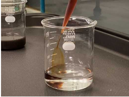
(1) 試料に塩化パラジウム溶液を加える。
