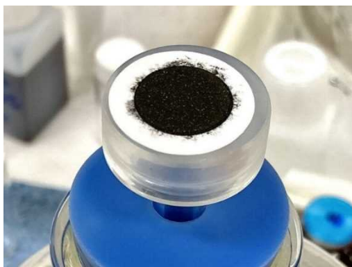
(5) 沈殿の様子 この後、沈殿をろ紙ごと乾燥する。
