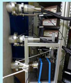
ウラン・プルトニウム混合粉末のプルトニウム量を測定する
