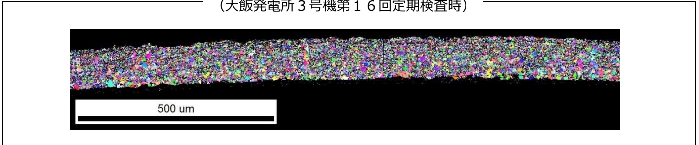
長期停止後スケール断面粒観察結果 (大飯発電所3号機第18回定期検査時)
