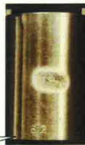
図2 ウォータージェットテスト後の外観 (700分間水噴流後の状況)
