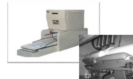
ホールボディカウンタ等設備整備
