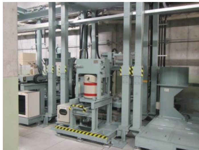
検査ユニット2 重量・線量当量率・放射能検査装置
