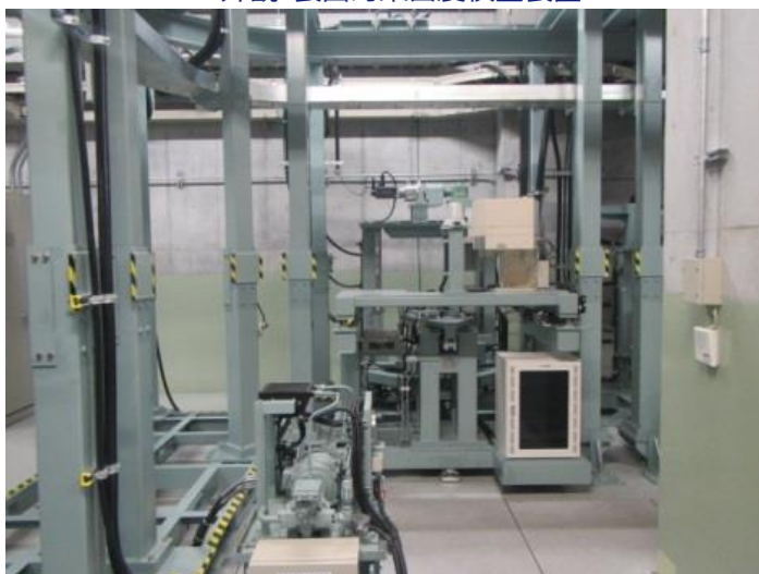
検査ユニット3 一軸圧縮強度検査・ラベリング装置
