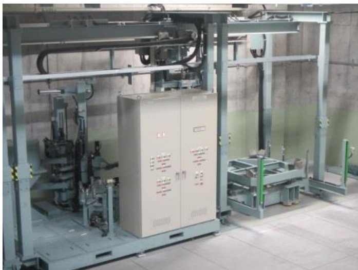
検査ユニット1 外観・表面汚染密度検査装置
