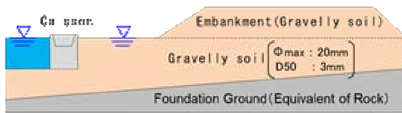
遠心模型実験モデル
