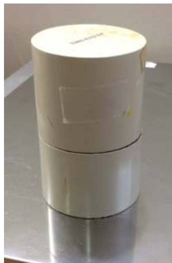
図2. 表示付認証機器を保管していた鉛容器
