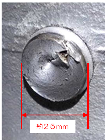
折損断面（駆動部側）
