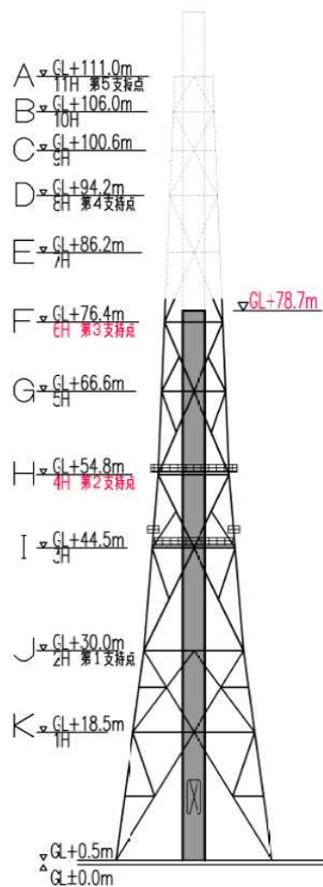
16ブロック解体後 第3支持点解体前
