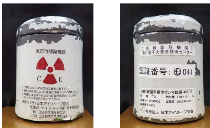
図3 線源を保管していた鉛容器（左：正面 右：背面）
