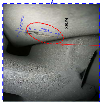
右図画像で一方における減肉箇所と推定される部位
